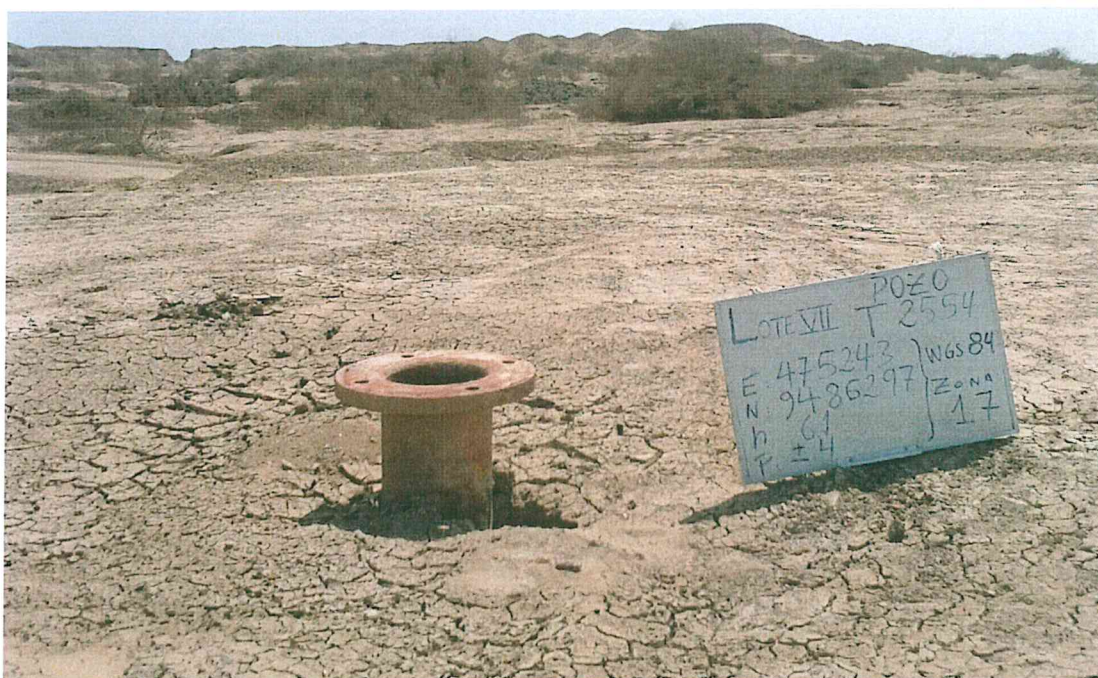
Fotografía N° 1. Pozo con código PERUPETRO T2554 y código Ficha OEFA F00586, se observa el casing expuesto a 0,25 m sobre el nivel de la superficie del suelo, no presenta cabezal o algún elemento de cierre por lo que se encuentra abierto al ambiente.
