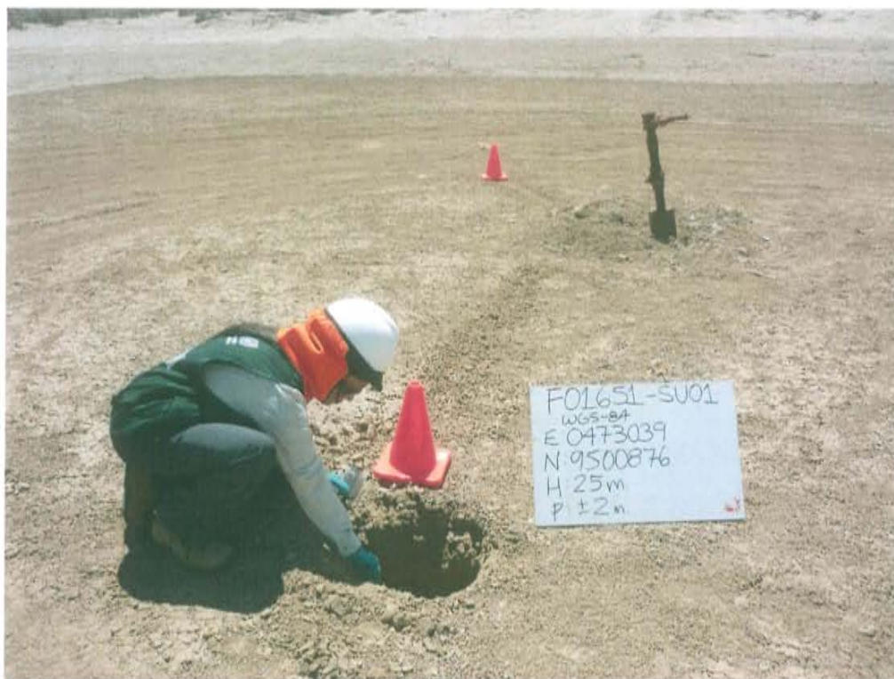
Fotografía N° 3. Toma de la primera muestra de suelo con código F01651-SU01 a 4 m de distancia del pozo y a 0,3 m de profundidad.
