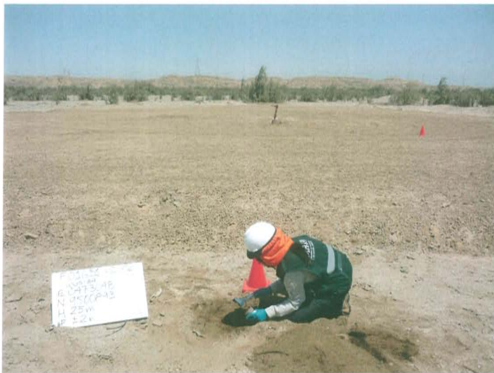
Fotografía N° 4. Toma de la segunda muestra de suelo con código F01651-SU02 a 9 m de distancia y a 03 m de profundidad.
