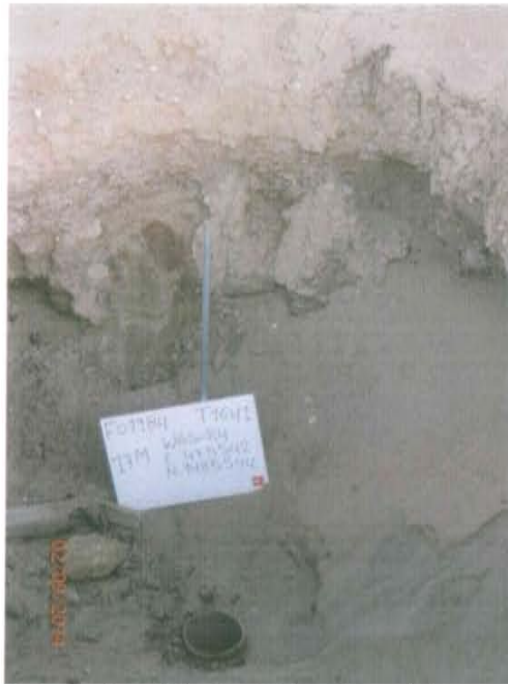
Fotografía N° 1. Ubicación del pozo inactivo ubicado en una excavación, con casing expuesto al ambiente.
