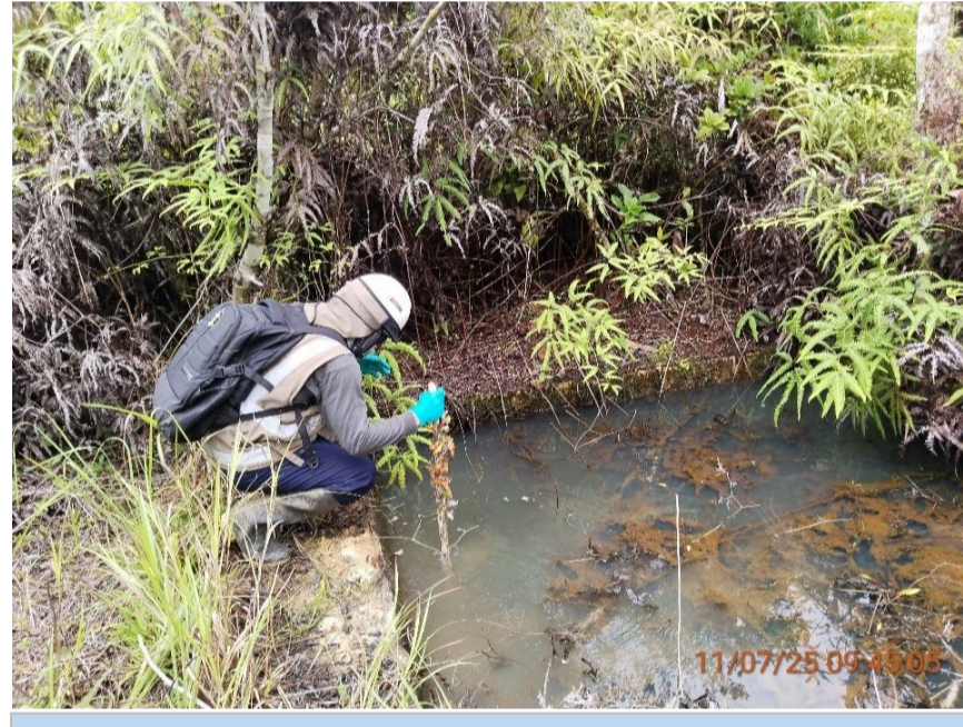
Vista de la poza de concreto con agua de lluvia acumulada y con medidas de 2,5 m (largo) x 2,5 m (ancho) x 1,65 m (profundidad), la cual se encuentra a una distancia de 2,80 m al sureste del punto de muestreo S0603-SU-002. Esta poza según lo indicado por los pobladores locales, habría sido utilizada como una trampa de grasa.
