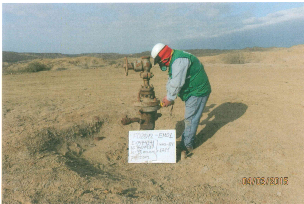
Fotografía N° 5. Vista de la medición de emisiones en el punto F02842-EM01 (boca de pozo)
