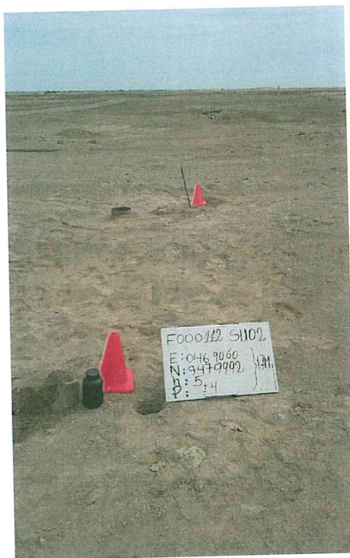
Fotografía N° 3. toma de muestra de suelo a 5 m al norte del pozo a una profundidad de 0,2 a 0,3 m de profundidad.
