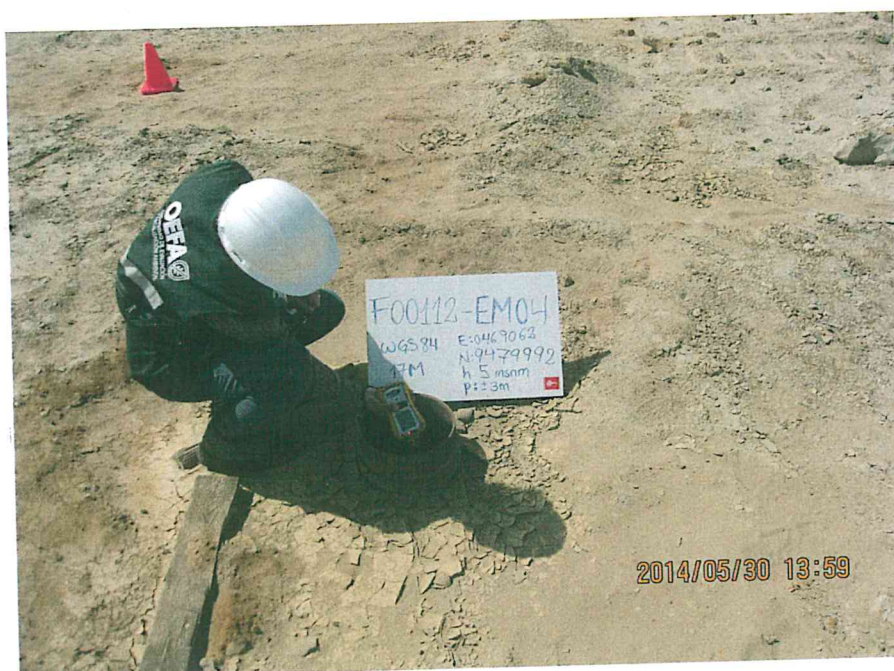
Fotografía N° 4. Medición de emisiones gaseosas fugitivas en boca de pozo
