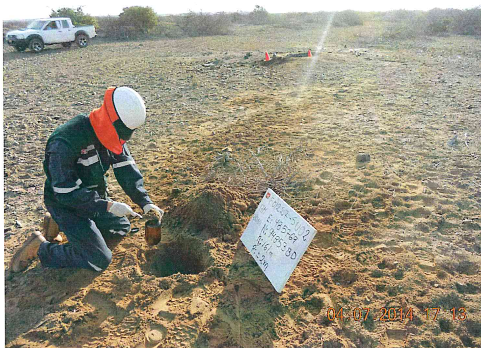
Fotografía N° 4. Toma de muestras de suelo en el punto F01227-SU02, a 16-m del pozo, se observa suelo con presencia de hidrocarburos.
