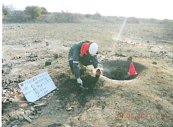
Fotografía N° 2. Toma de muestras de suelo en el punto F01227-SU01, se observa pozo abierto al ambiente, cortado en un lado del extremo inferior del casing intermedio, de donde posiblemente se extraen artesanalmente hidrocarburos.
