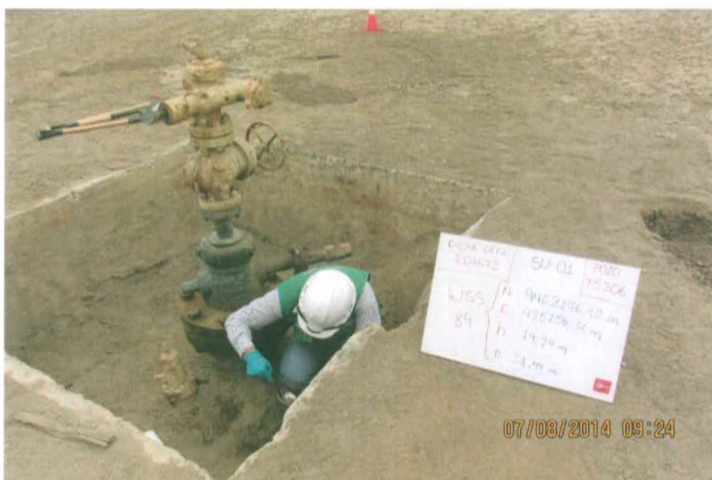
Fotografía N° 3. Toma de muestra de suelo en el punto F01673-SU01, ubicado a 0,5 m del pozo.
