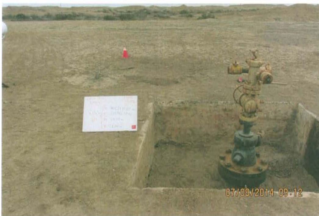
Fotografía N° 1. Se observa el cabezal del pozo compuesto por un arreglo de tuberías, bridas y válvulas con signos de corrosión que posiblemente no aseguran hermetismo del pozo.
