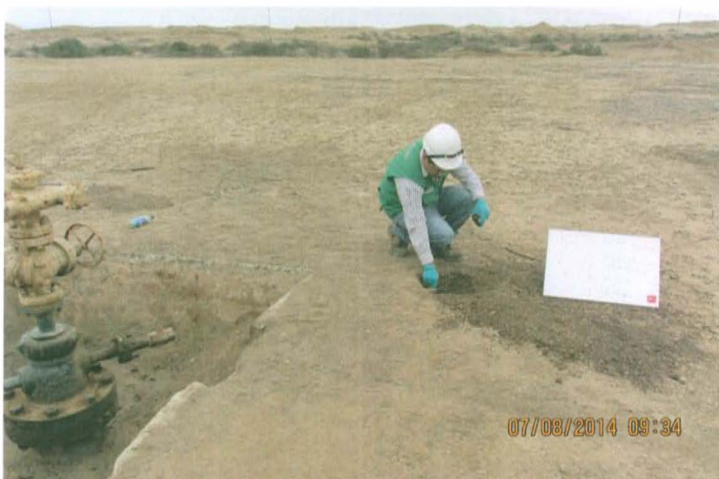
Fotografía N° 4. Toma de muestra de suelo en el punto F01673-SU02, ubicado a 2,8 m del pozo.
