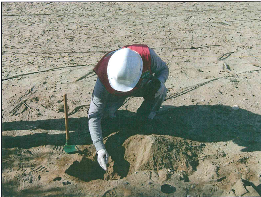
Fotografía N° 3.-Toma de muestras en forma puntual de suelo en el área de posible ubicación del pozo T3173.
