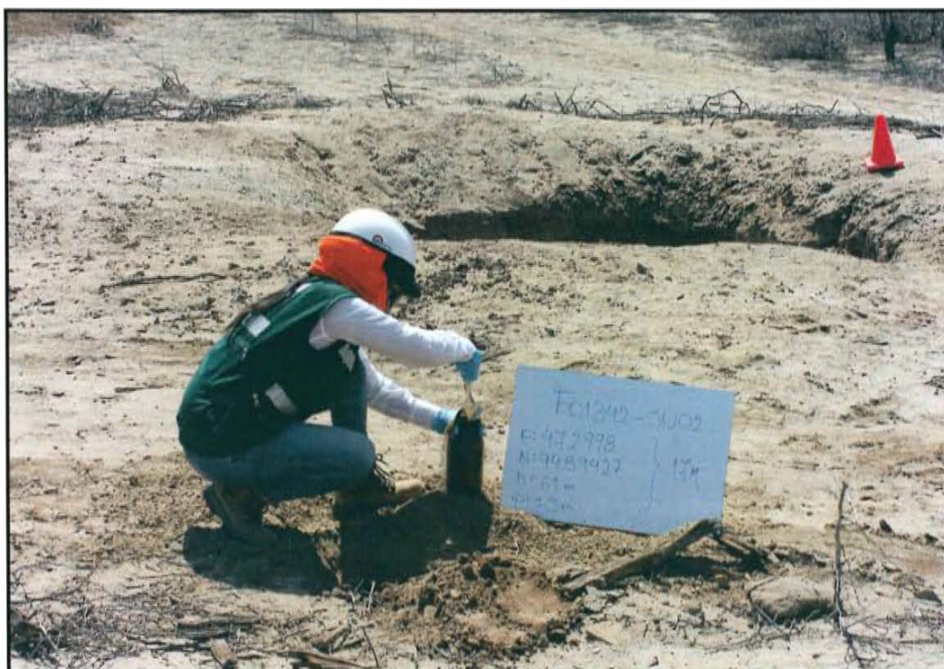
Fotografía N° 4. Toma de muestra en el punto F01342-SU02, ubicado a 7,2 m de distancia del casing del pozo T2279 a una profundidad de 0,45 m de la superficie del suelo.
