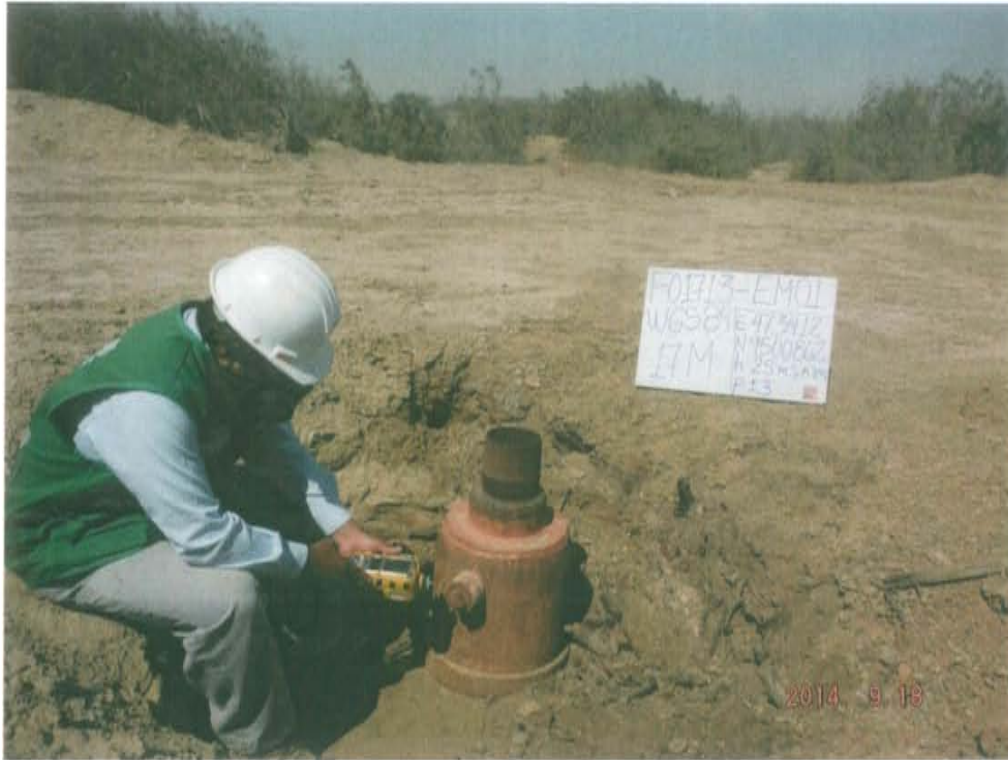
Fotografía N° 5. Medición de emisiones gaseosas fugitivas en el punto F01713-EM01, ubicado en la fuente de emisión en boca del Pozo T3749.
