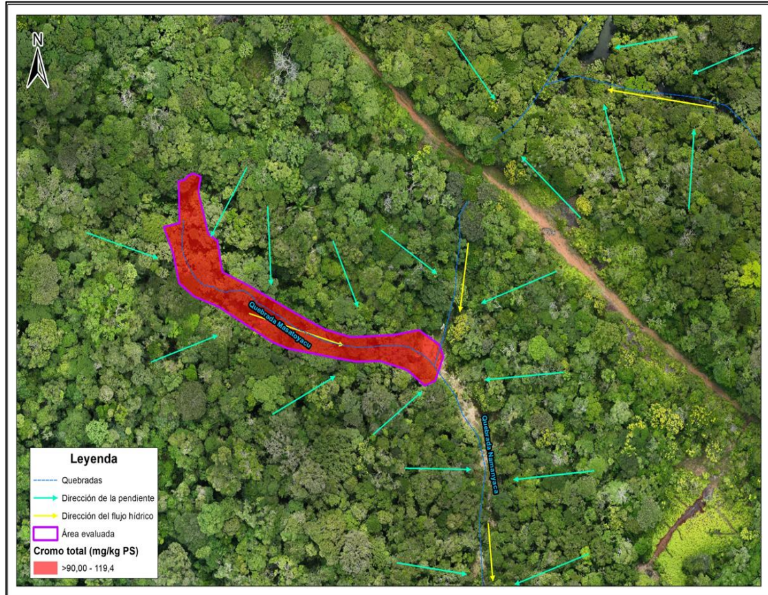
Figura 8.2. Distribución espacial de concentraciones de cromo total en sedimento del sitio S0602
