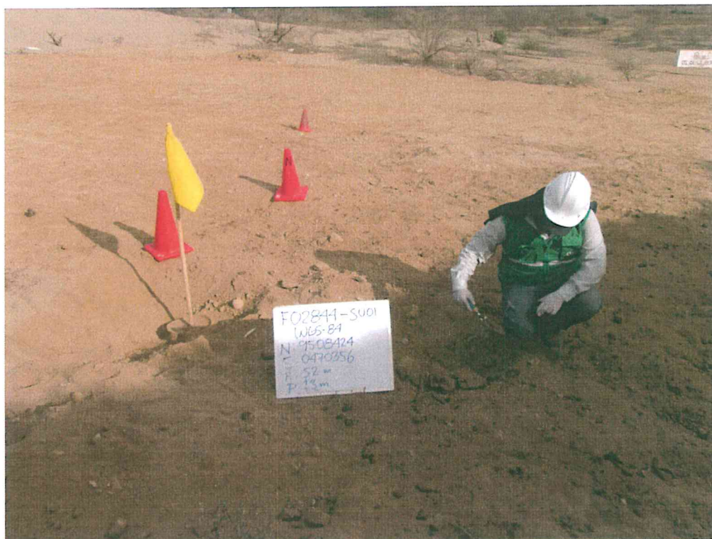
Fotografía N° 3. Toma de muestra de suelo en el punto F02844-SU01, ubicado aproximadamente a 1,3 m al oeste del Pozo L_404.
