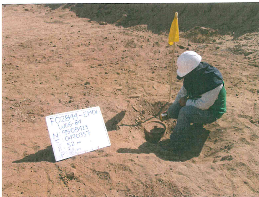
Fotografía N° 4. Medición en el punto F02844-EM01, ubicado en una posible fuente de emisión del Pozo L_404.
