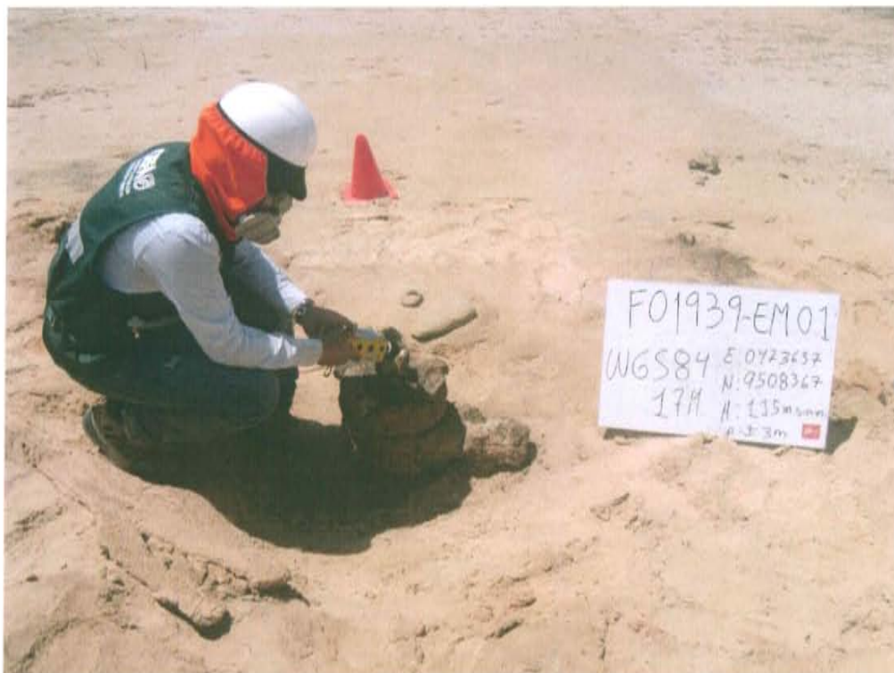
Fotografía N° 4. Medición en el punto F01939-EM01, ubicado en la fuente de emisión en boca del Pozo L9399.
