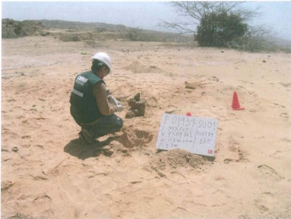
Fotografía N° 3. Toma de muestra de suelo en el punto F01939-SU01, ubicado aproximadamente a 2 m al noreste del Pozo L9399.
