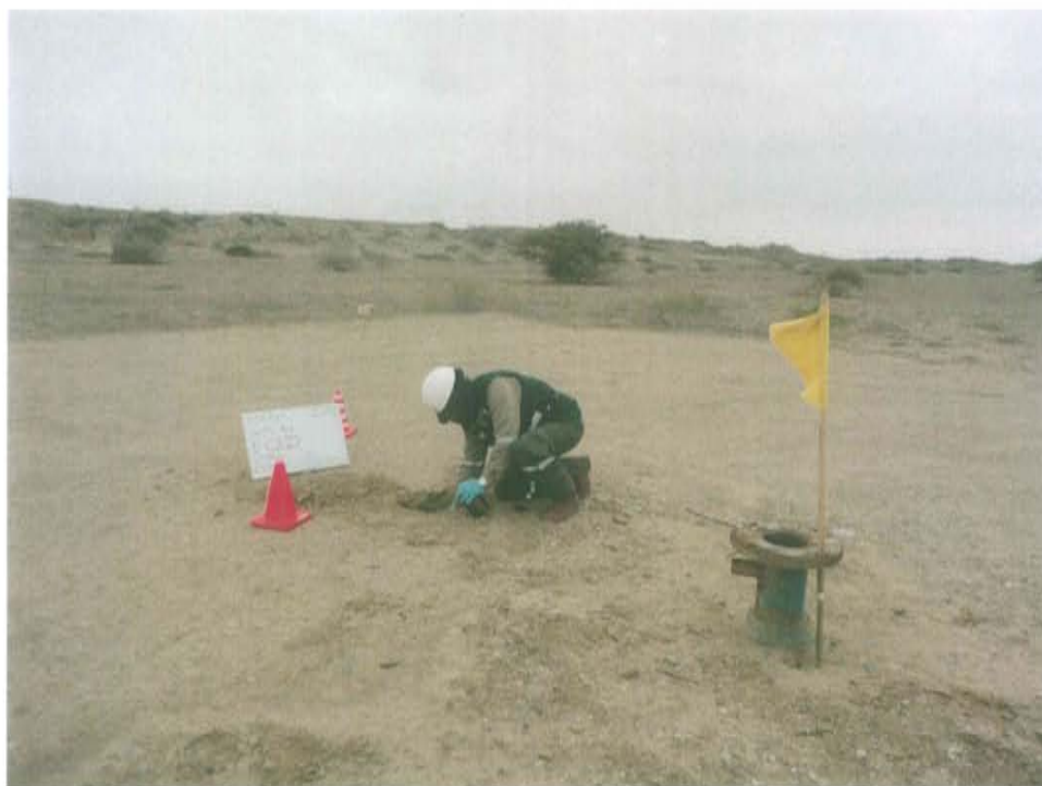
Fotografía N° 3. Toma de muestra de suelo con presencia de hidrocarburo en zonas adyacentes al pozo.
