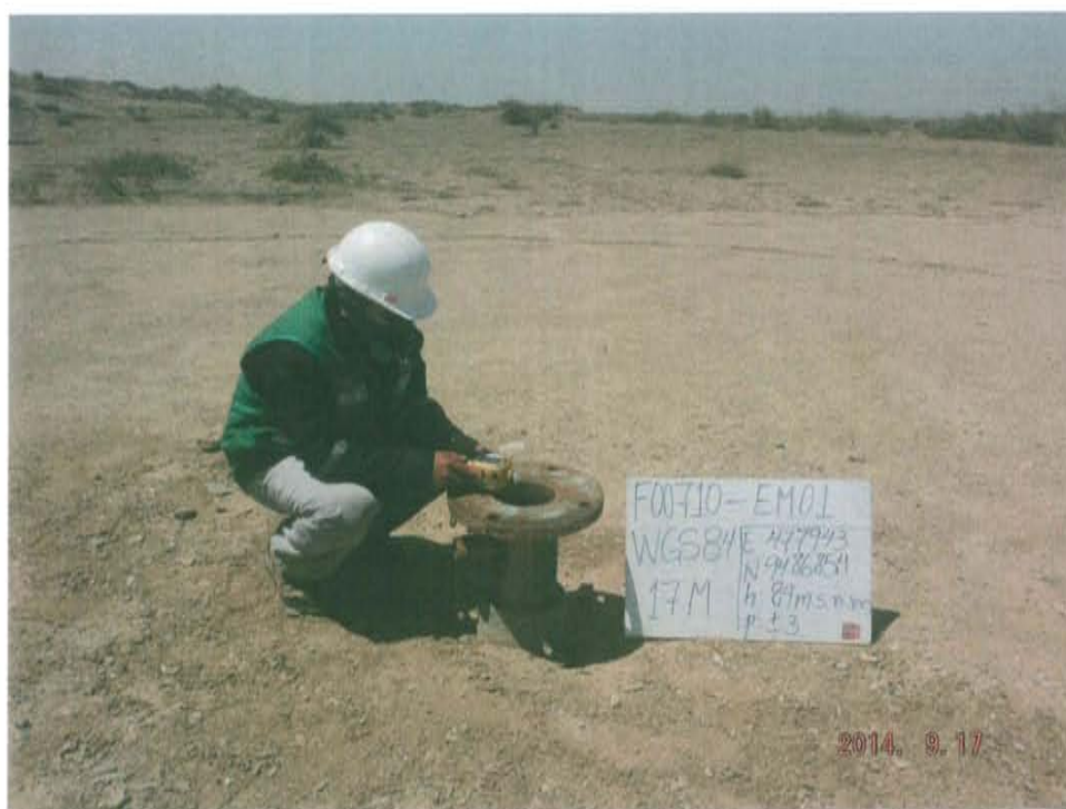
Fotografía N° 4. Medición de emisiones fugitivas provenientes del pozo T3993
