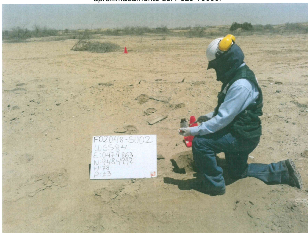
Fotografía N° 4. Toma de muestra de suelo en el punto F02048-SU02, ubicado a 7,5 m aproximadamente del Pozo T3053.
