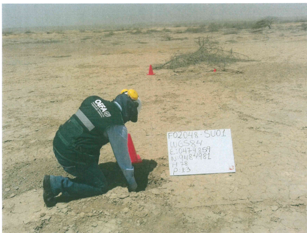
Fotografía N° 3. Toma de muestra de suelo en el punto F02048-SU01, ubicado a 4,5 m aproximadamente del Pozo T3053.
