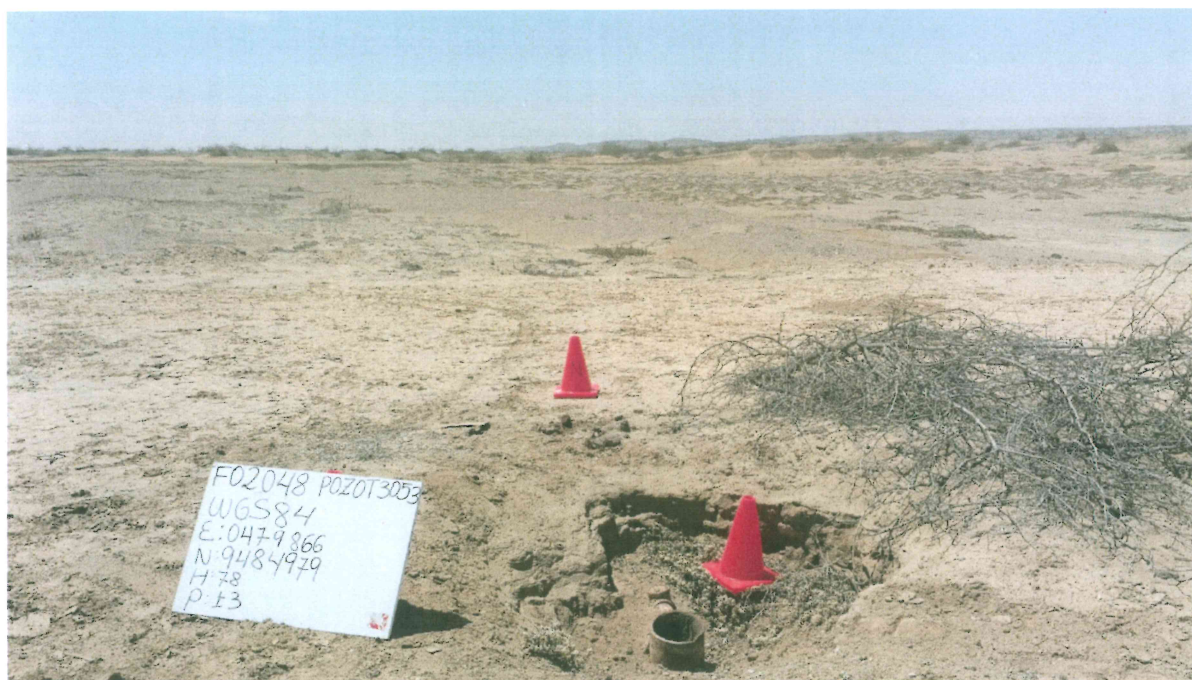
Fotografía N° 1. Pozo inactivo con código PERUPETRO T3053 cuyo casing, corroído y expuesto al ambiente, se encuentra en el interior de un hoyo de forma irregular.
