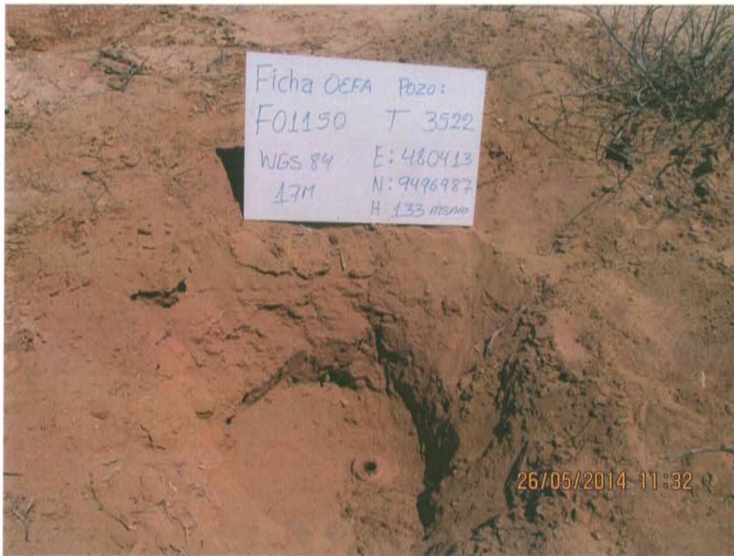
Fotografía N° 1. Se observa a nivel superficial una tubería de reducción en el interior de un hoyo de aproximadamente 0,45 m de profundidad.
