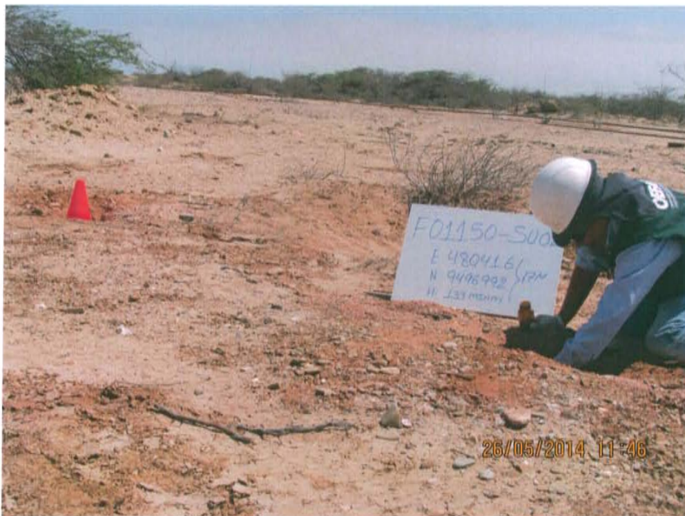
Fotografía N° 4. Toma de muestra de suelo en el punto F01150-SU02, ubicado a 2,4 m aproximadamente al este del Pozo T 3522.
