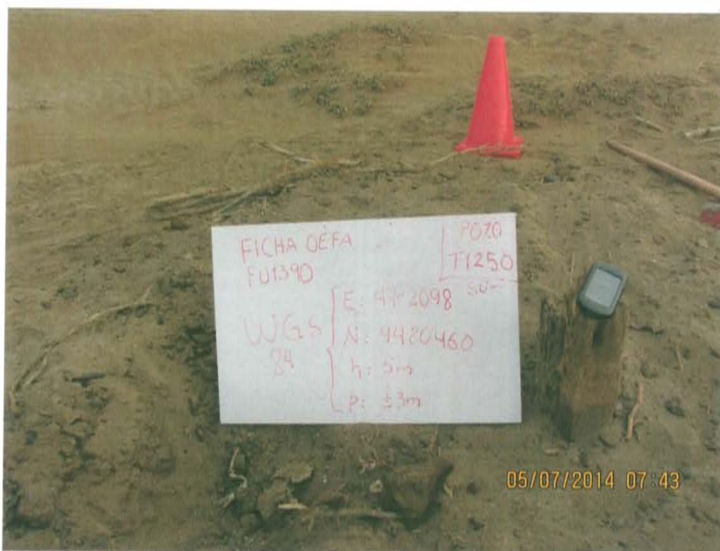
Fotografía N° 1. Se observa casing a nivel de la superficie del suelo y en su interior contiene un tronco de madera.
