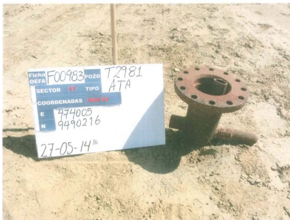
Fotografía N° 1. Identificación del pozo inactivo con código PERUPETRO T2981 que presenta casing abierto y en estado de corrosión.
