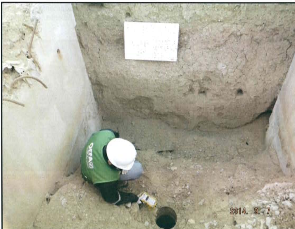
Fotografía N° 4. Medición de emisiones fugitivas en boca de pozo.
