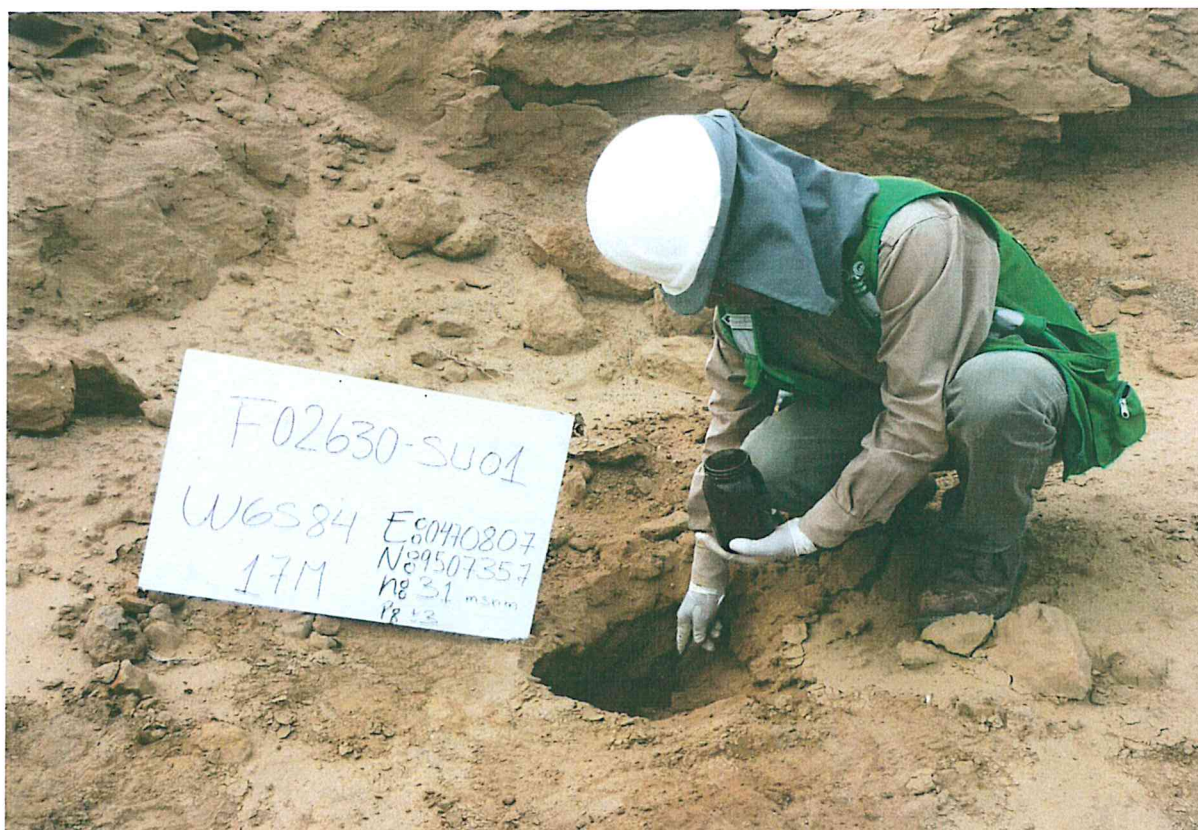
Fotografía N° 3. Muestra puntual de suelo tomada a 1 m en dirección Sur-Este del Pozo L_442.
