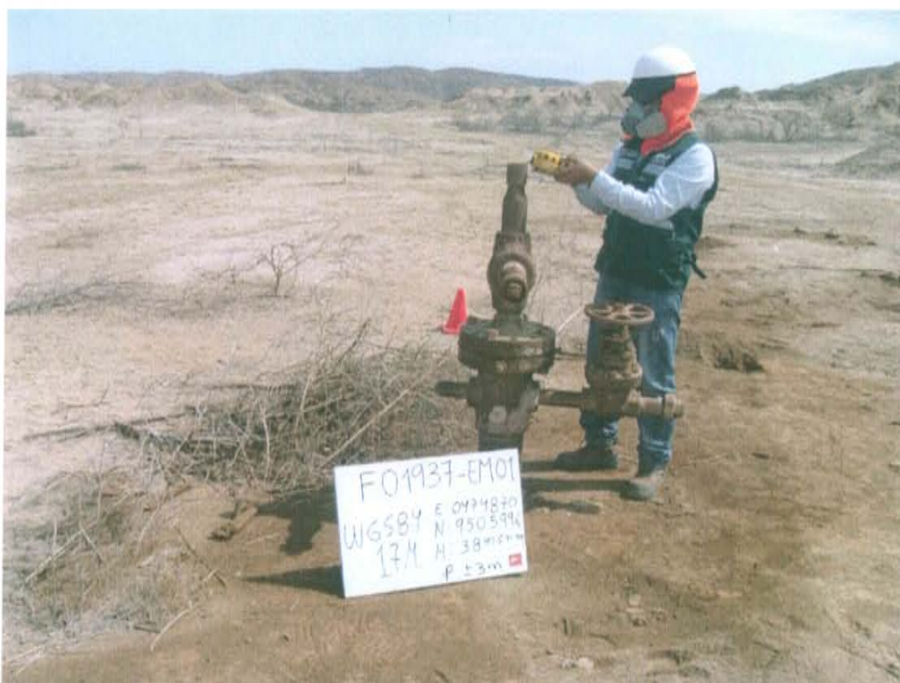
Fotografía N° 4. Medición en el punto F01937-EM01, ubicado en la fuente de emisión en boca del Pozo LJ_55.
