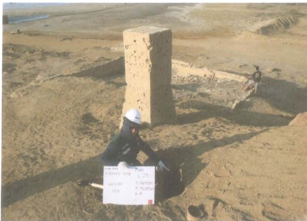
Fotografía N° 3. Toma de muestra de suelo en el punto F00975-SU01, aproximadamente a 0,5 m del pozo L_290.
