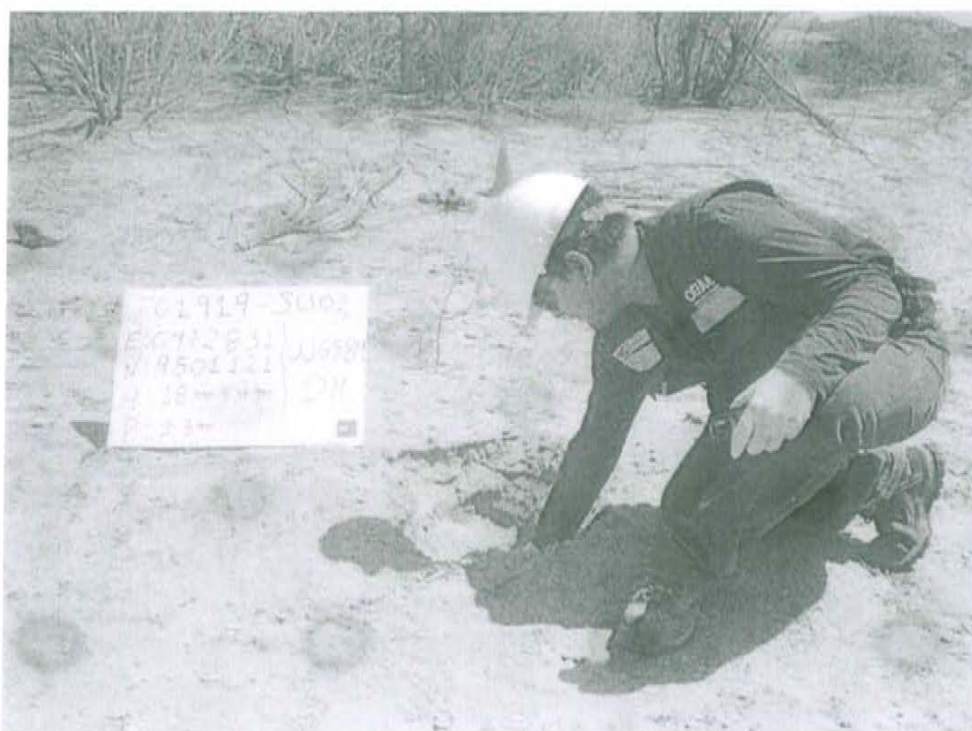
Fotografía N° 2. Toma de muestra de suelo en el punto F01919-SU02, ubicado a 9,5 m aproximadamente del Pozo T3429.
