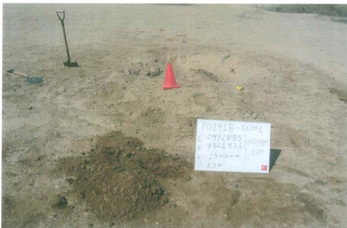
Fotografía N° 3. Toma de muestra de suelo en el punto F01918-SU01, ubicado a 3 m aproximadamente del Pozo T3529.
