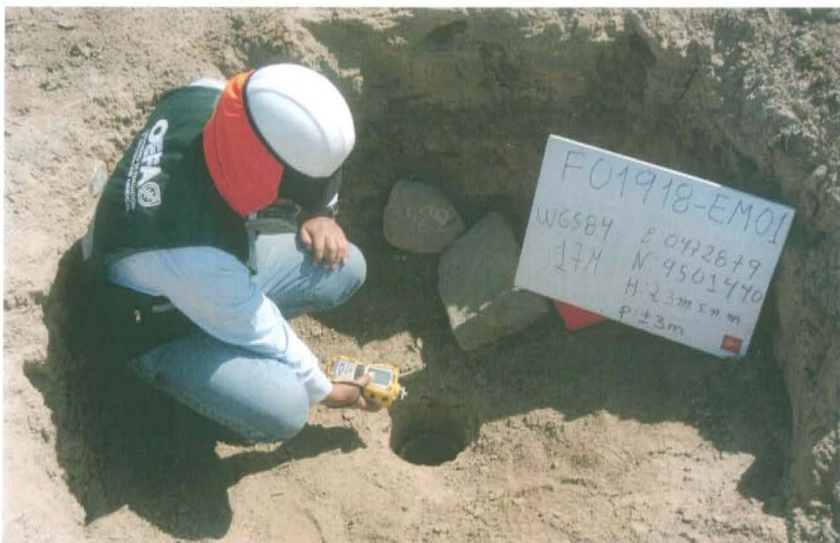
Fotografía N° 5. Medición en el punto F01918-EM01, ubicado en la fuente de emisión en boca del Pozo T3529.
