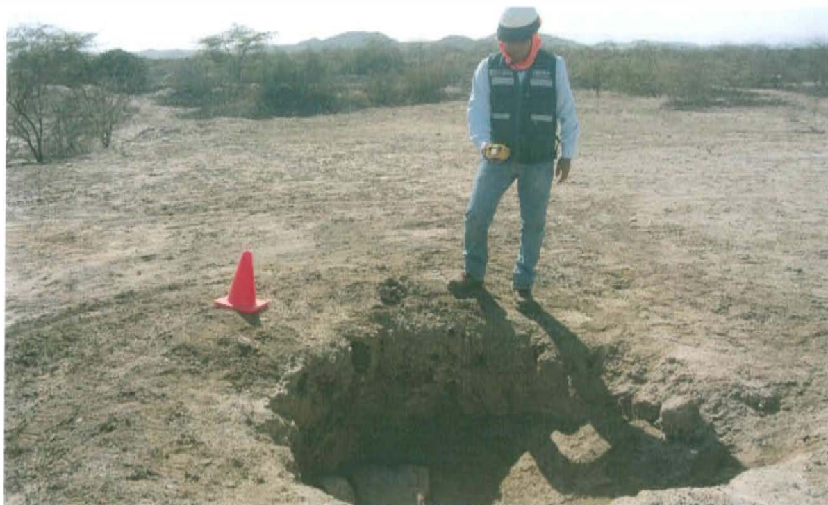
Fotografía N° 6. Mediciones en el punto F01918-VA01, se realizó un recorrido en el área circundante alrededor del pozo en un radio de 1 m, con una duración de 10 minutos.
