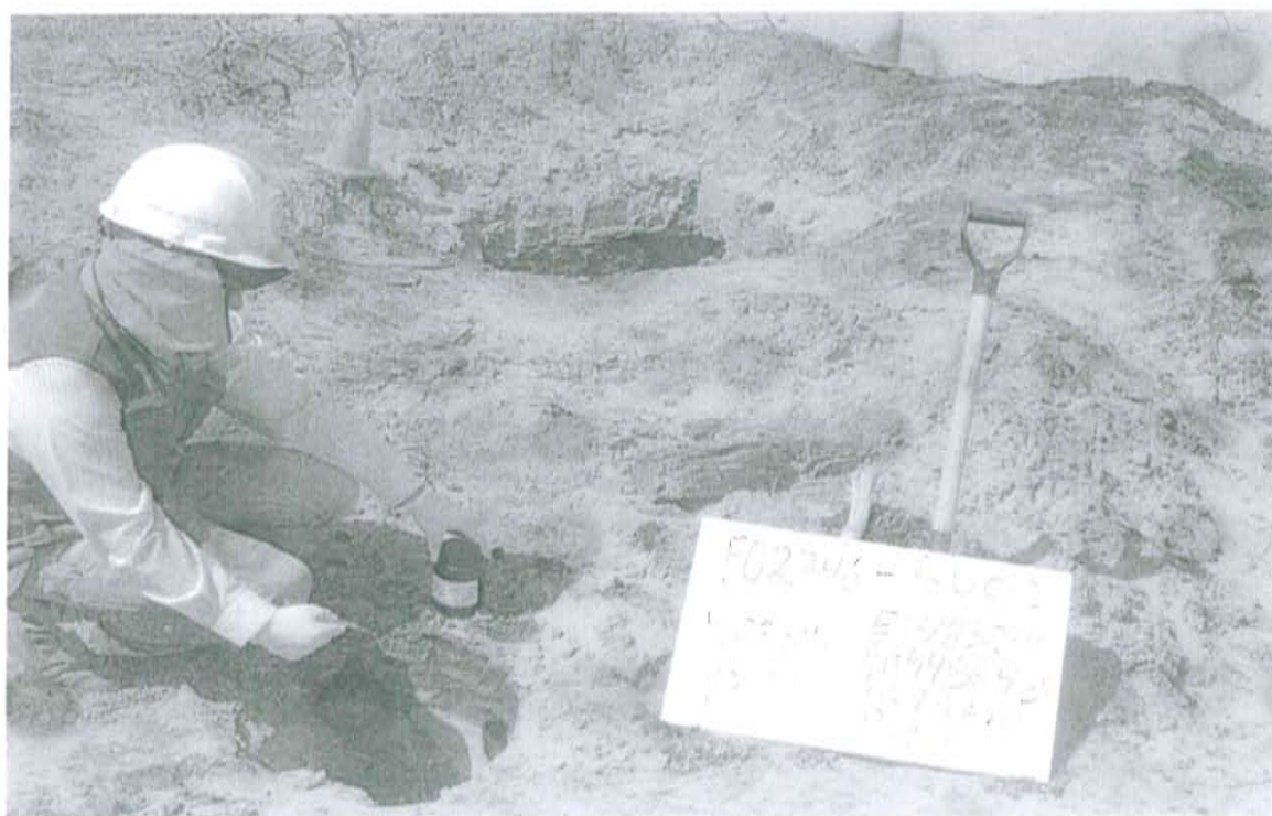
Fotografía N° 2. Toma de muestra de suelo en el punto F02746-SU02, ubicado a 5 m de la posible ubicación del pozo.
