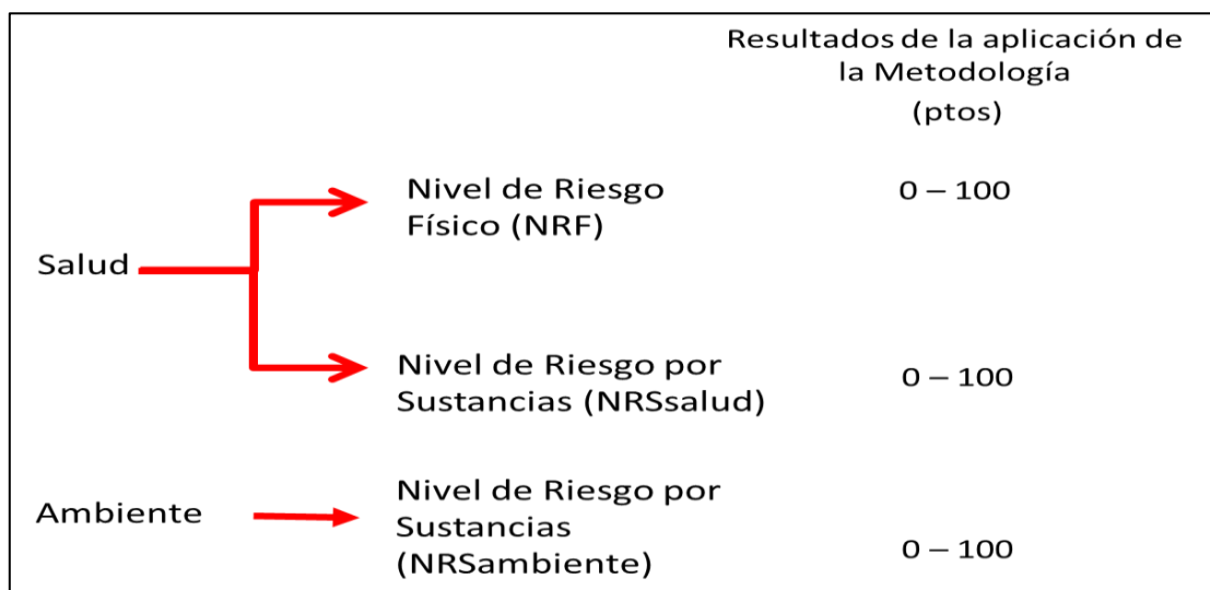
Figura 7.8. Indicadores de riesgos por presencia de peligros de tipo físico y por presencia de sustancias contaminantes
