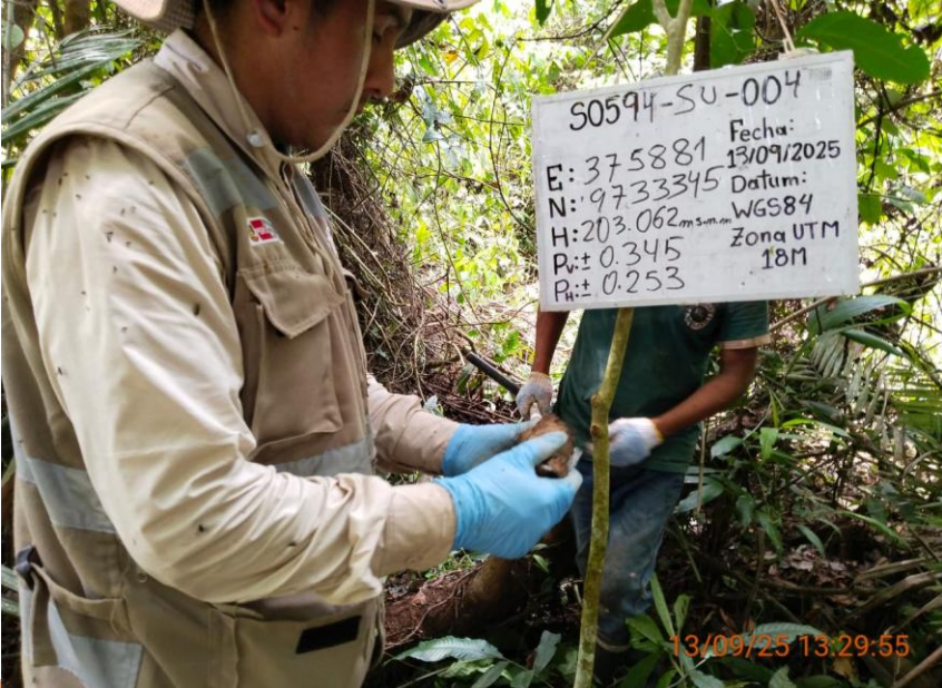
Vista de la toma de muestra de suelo con código S0594-SU-004. Se observó suelo húmedo de textura arcillosa y con indicios organolépticos de hidrocarburos (olor).
