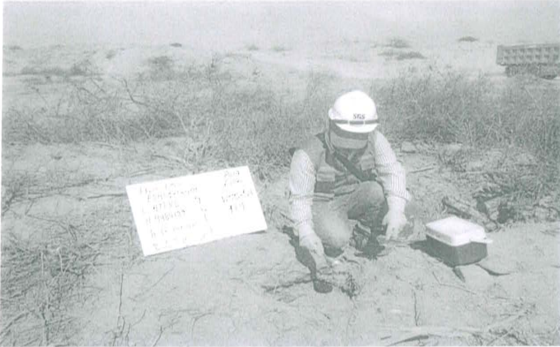
Fotografía N° 1. Toma de muestra de suelo en el punto F01951-SU01, ubicado a 2 m aproximadamente del Pozo.
