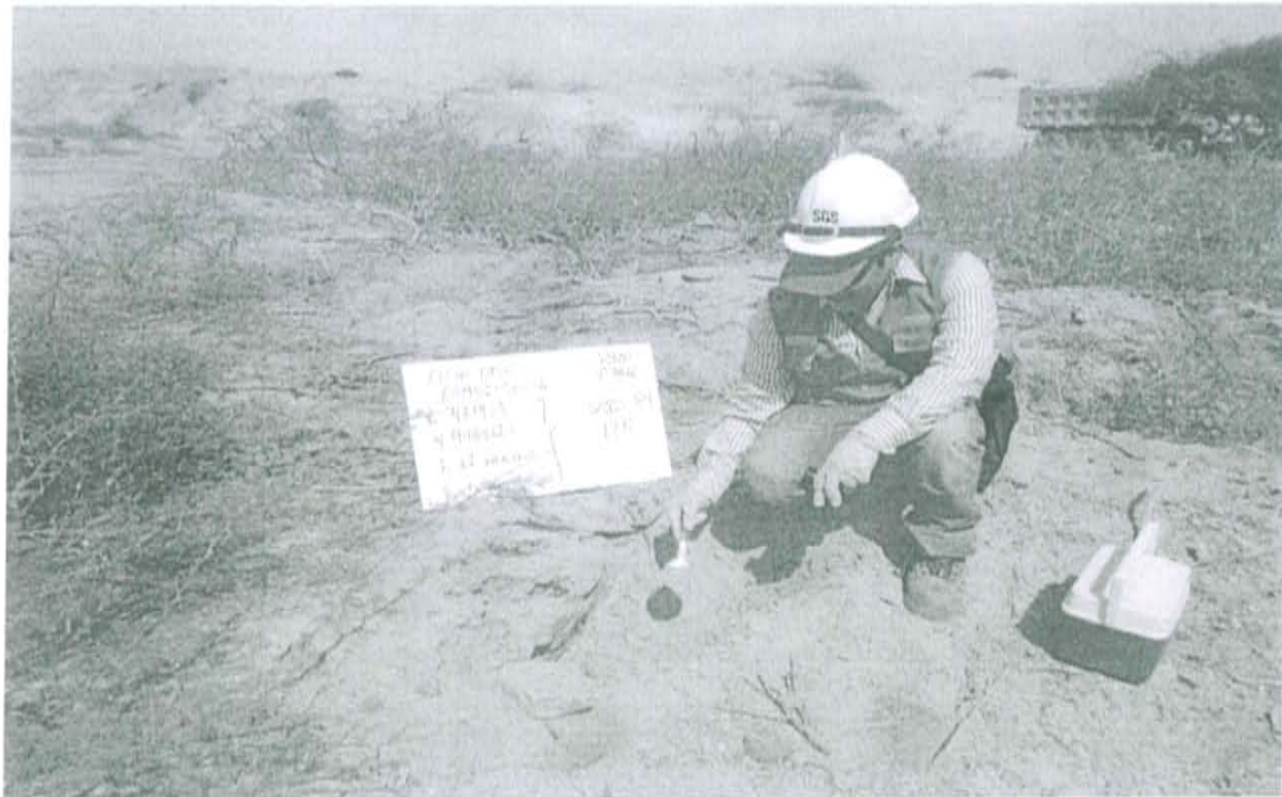
Fotografía N° 2. Toma de muestra de suelo en el punto F01951-SU02, ubicado a 5 m aproximadamente del Pozo.
