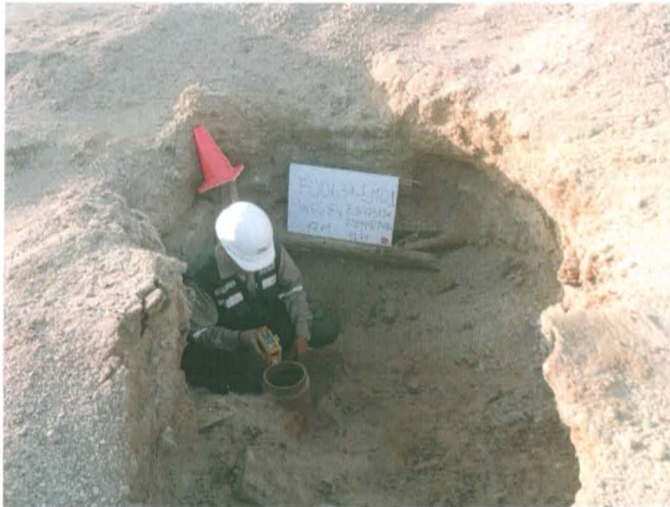
Fotografía N° 3. Toma de muestra de suelo F00637-EM01 en boca del Pozo T 3839.
