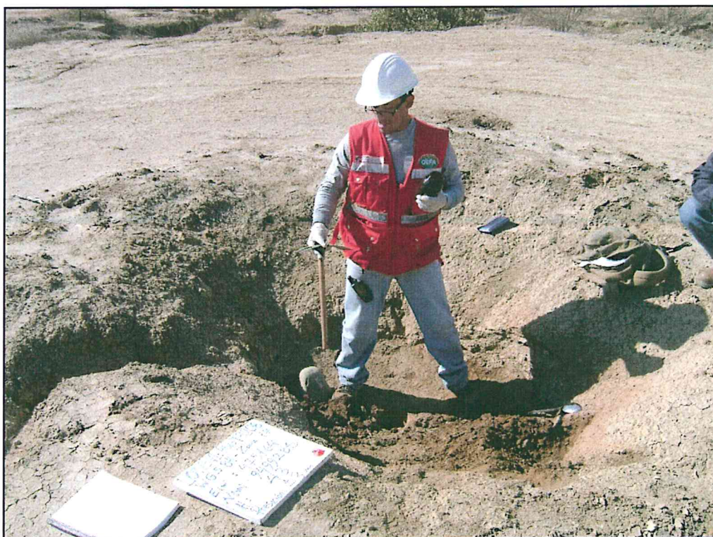
Fotografía N° 2. Vista del área circundante del Pozo T3208 que presenta suelo contaminado con hidrocarburos.
