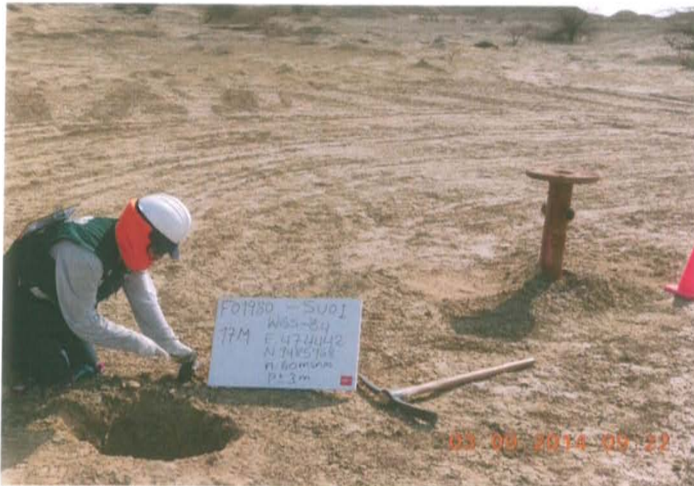
Fotografía N° 3. Toma de muestra de suelo en el punto F01980-SU01, ubicado a 2,27 m del Pozo T180.
