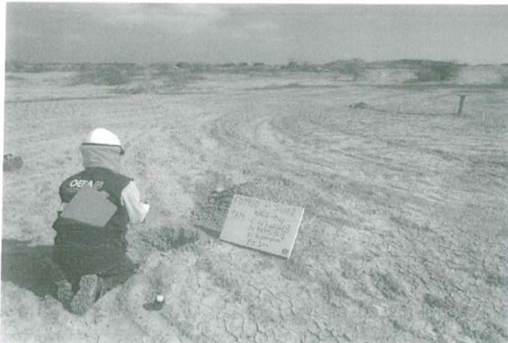
Fotografía N° 2. Toma de muestra de suelo en el punto F01980-SU02, ubicado a 12 m del Pozo T1980.
