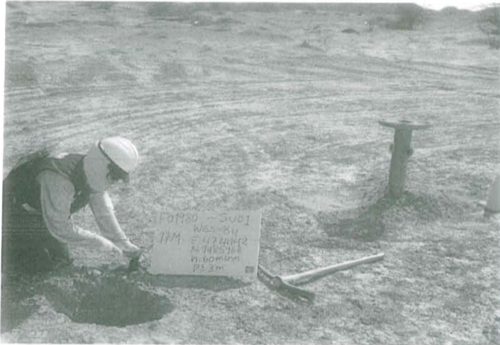
Fotografía N° 1. Toma de muestra de suelo en el punto F01980-SU01, ubicado a 2,27 m del Pozo T1980.
