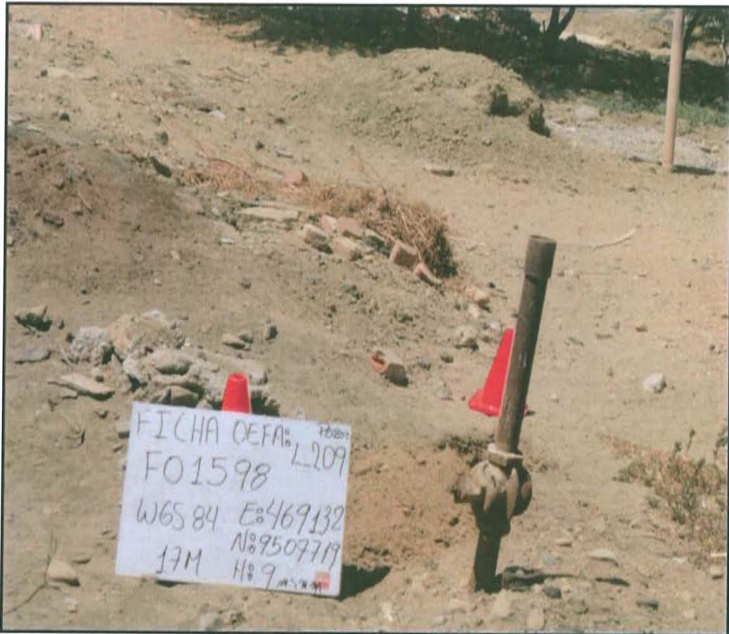
Fotografía N° 1. Pozo inactivo, con cabezal enterrado se observa tubo de reducción con tierra en su interior.
