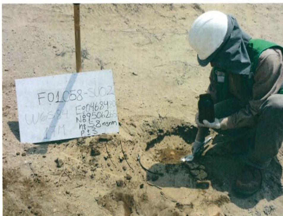
Fotografía N° 4. Muestra puntual de suelo tomada a 2 m en dirección Nor-Oeste del Pozo L_147.
