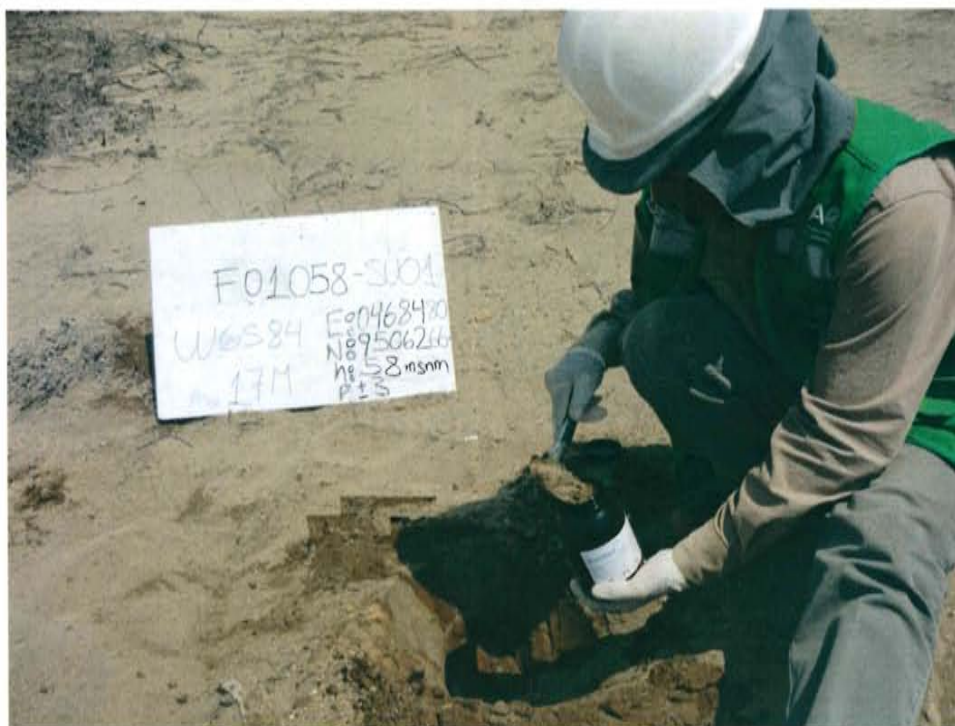
Fotografía N° 3. Muestra puntual de suelo tomada a 1 m en dirección Norte del Pozo L_147.
