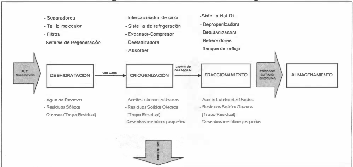
Diagrama N°01. Proceso de la Planta Criogénica
