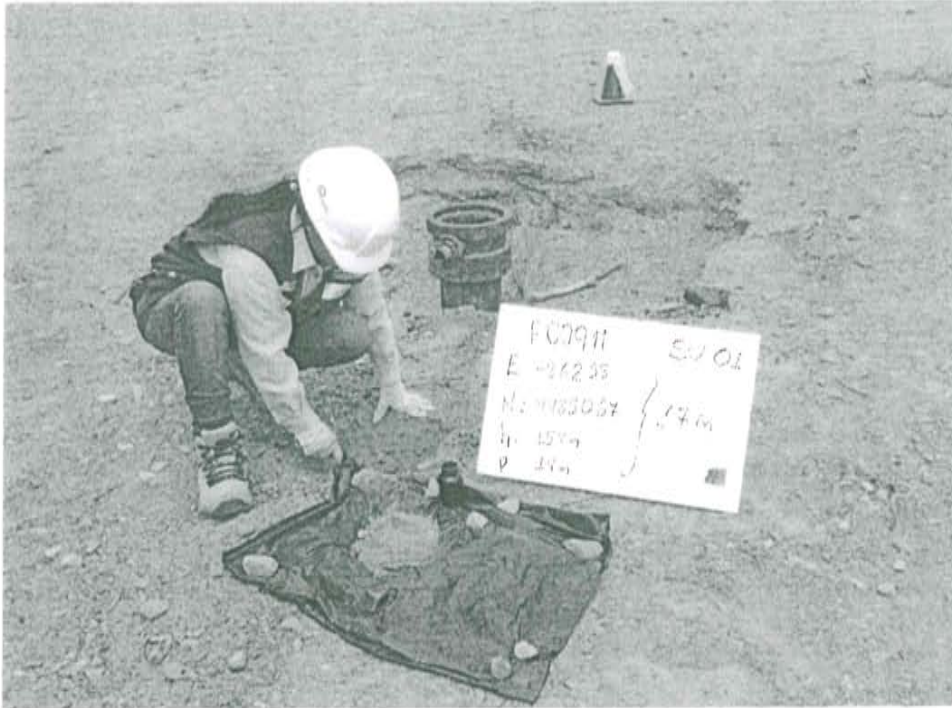
Fotografía N° 1. Toma de muestra en el punto F00911-SU01, ubicado a 2.4 m de distancia del casing del pozo T2360 a una profundidad de 0.20 m de la superficie del suelo.
