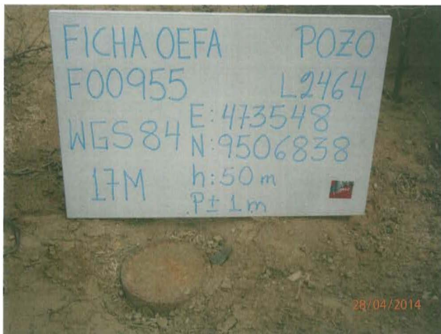
Fotografía N° 1. Pozo L2464, presenta casing de aproximadamente 6½ pulgadas de diámetro con tapa de fierro soldada.
