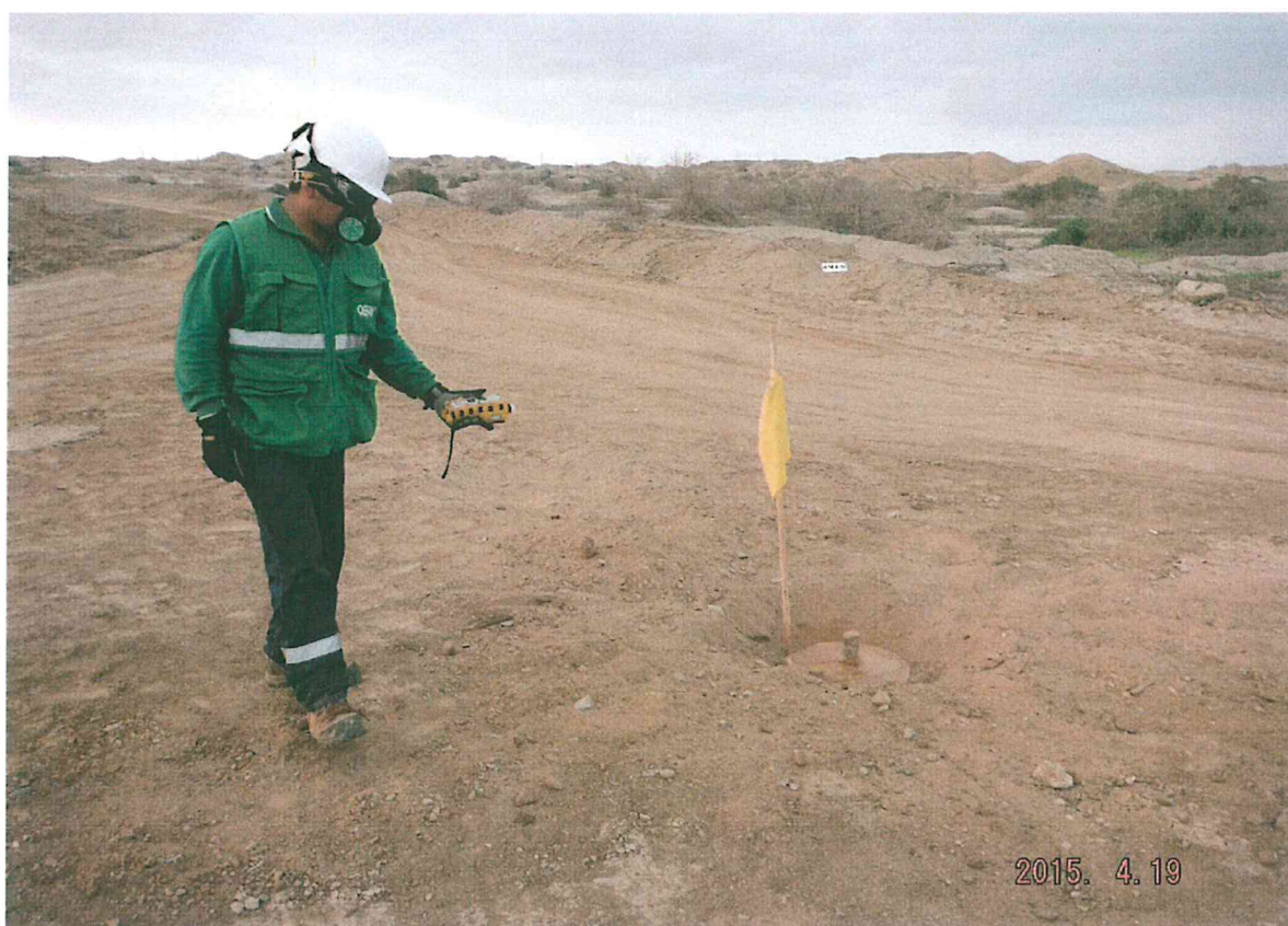
Fotografía N° 6. Mediciones en F02940-VA01, recorrido en el área circundante alrededor de la fuente de emisión del pozo T3057.
