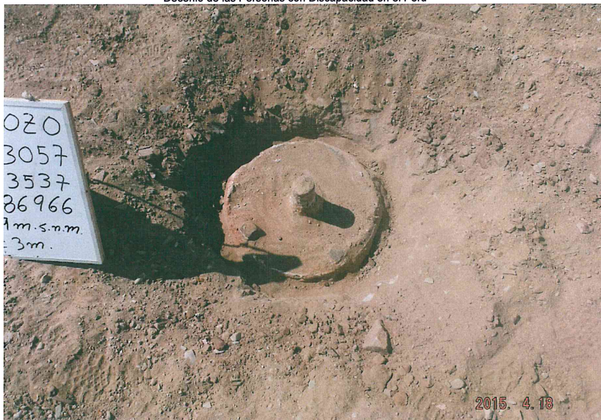
Fotografía N° 1. Pozo con código PERUPETRO T3057 y código Ficha OEFA F02940, donde se observa el pozo a 0,05 m debajo del nivel de la superficie del suelo, con una brida reductora y una tubería de 2 plg sin algún elemento de cierre por lo que se encuentra abierto al ambiente.
