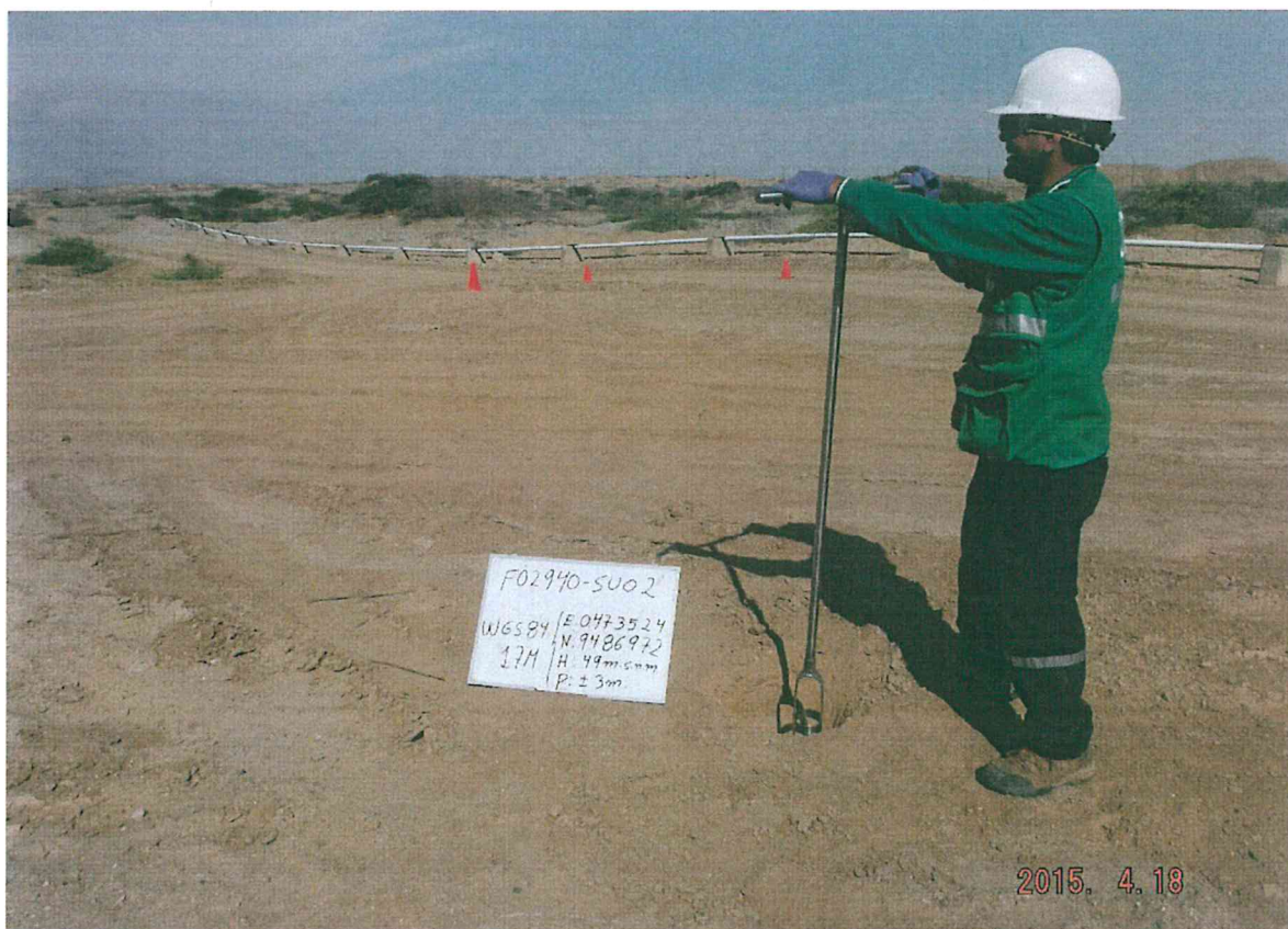
Fotografía N° 4. Toma de muestra de suelo en el punto F02940-SU02, ubicada a 4 m aproximadamente del Pozo T3057.
