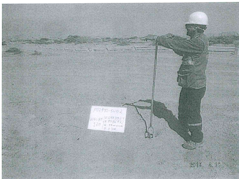
Fotografía N° 2. Toma de muestra de suelo en el punto F02940-SU02, ubicado a 4 m aproximadamente del Pozo T3057.
