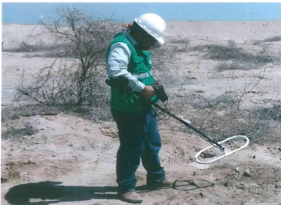
Fotografía N° 1. El equipo de Búsqueda usando el detector de metales y buscando el pozo L_303.
