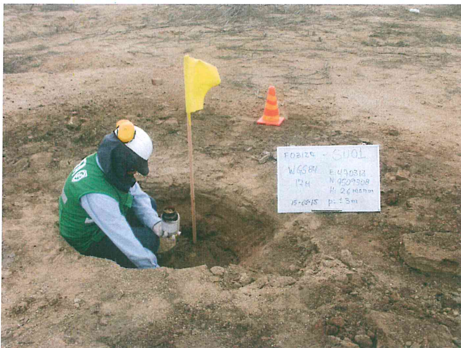
Fotografía N° 3. Toma de muestra puntual de suelo FO3123-SU01 a 0,25 m al sureste del pozo y a una profundidad de 0,5 m
