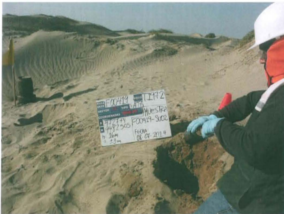
Fotografía N° 4. Toma de muestra de suelo en el punto F00419-SU02, ubicado a 4 m aproximadamente del Pozo T1972.
