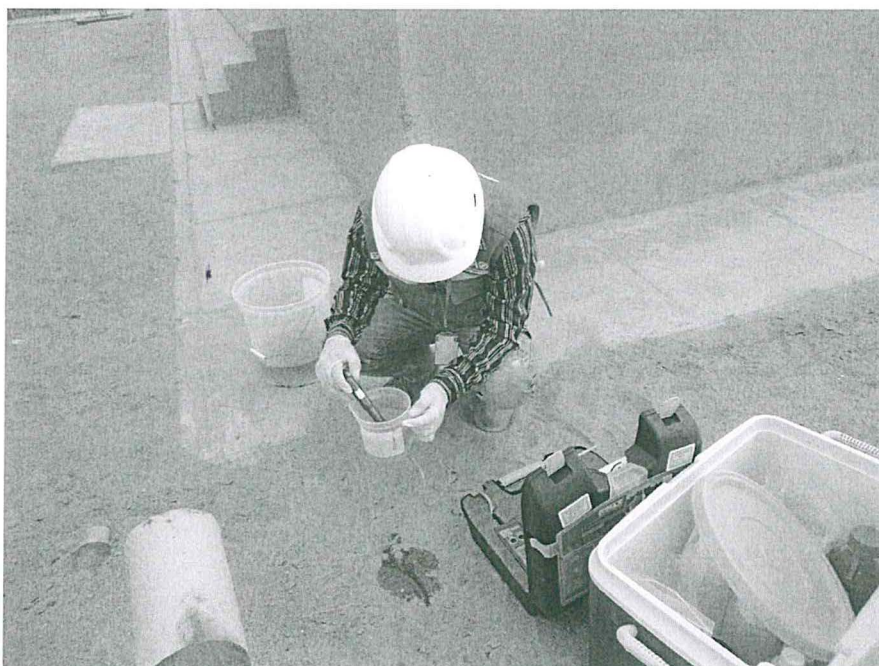
Fotografía N° 3: Medición de pH, T° y cloro residual del Punto EFLU-01.
