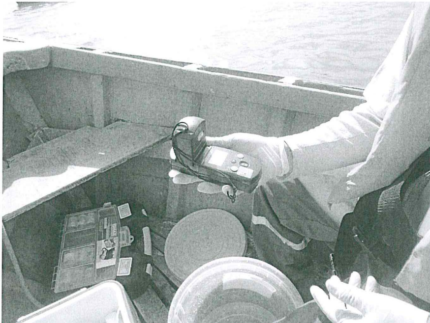
Fotografía N° 10: Medición de pH, T° y cloro residual del Punto MAR-02.
