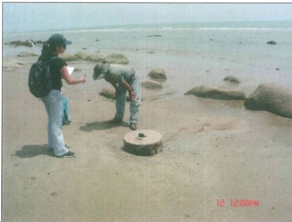
Fotografía N° 5. Foto extraída del EIA para el "Proyecto de Explotación de Hidrocarburos en las áreas de Zorritos - Copé y Carpitás - Punta Bravo, Lote XX". El cual señala existencia del pozo mal abandonado que presenta emanación de hidrocarburos y gas en el distrito de Zorritos de la provincia Contralmirante Villar del departamento de Tumbes.
