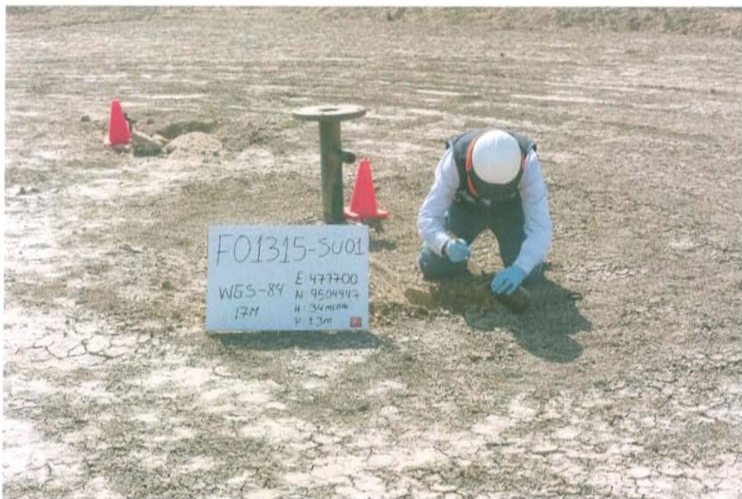
Fotografía N° 3. Toma de muestra de suelo en el punto F01315-SU01, ubicado a 1,7 m aproximadamente al suroeste del Pozo T5307.
