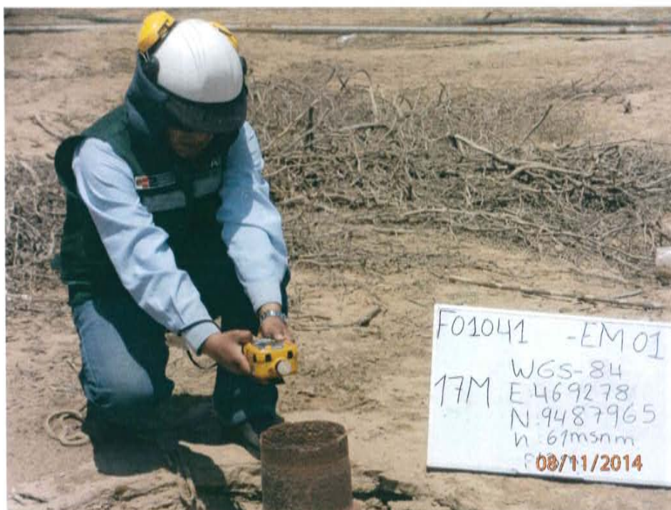
Fotografía N° 4. Muestreo de emisiones gaseosas fugitivas en boca de pozo T_786.
