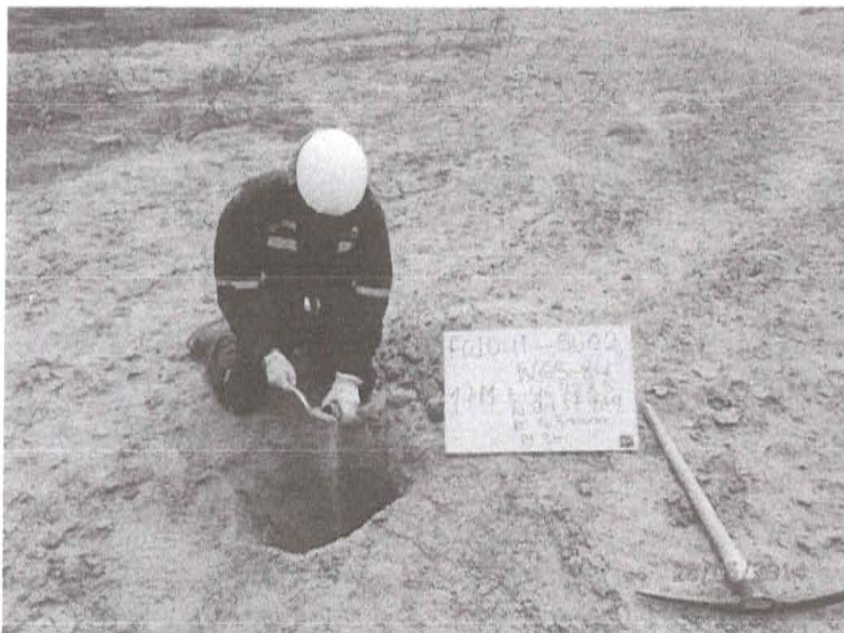
Fotografía N° 2. Toma de muestra de suelo en el punto F01041-SU02, ubicado a 15 m aproximadamente del Pozo T_786.
