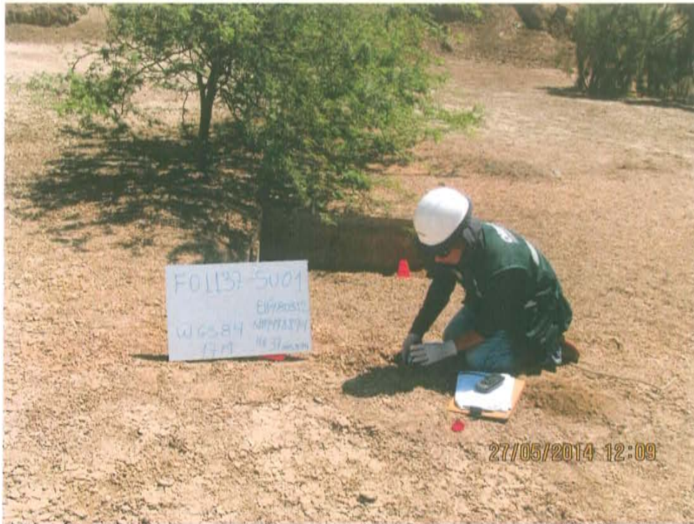
Fotografía N° 3. Toma de muestra de suelo en el punto F01137-SU01, ubicado a 2,3 m aproximadamente al sureste del Pozo T3785.
