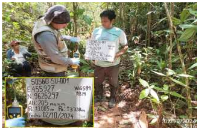
Medición de compuestos orgánicos volátiles (COV) en el punto S0560-SU-001, reportando una lectura de 0,5 ppm.
