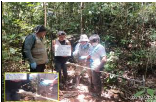
Toma de muestra de suelo en el punto S0560-SU-004, a una profundidad de 0,40 m – 0,90 m, donde se identificó un suelo de textura limo arcillosa,
