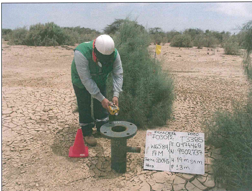
Fotografía N° 5. Medición en el punto F03012-EM01, ubicado en la fuente de emisión de la boca del Pozo T3385, en dos intervalos de 3 minutos.
