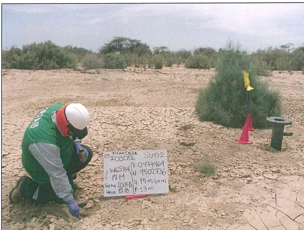
Fotografía N° 4. Toma de muestra de suelo en el punto F03012-SU02, ubicado a 3 m de distancia aproximadamente del Pozo T3385.
