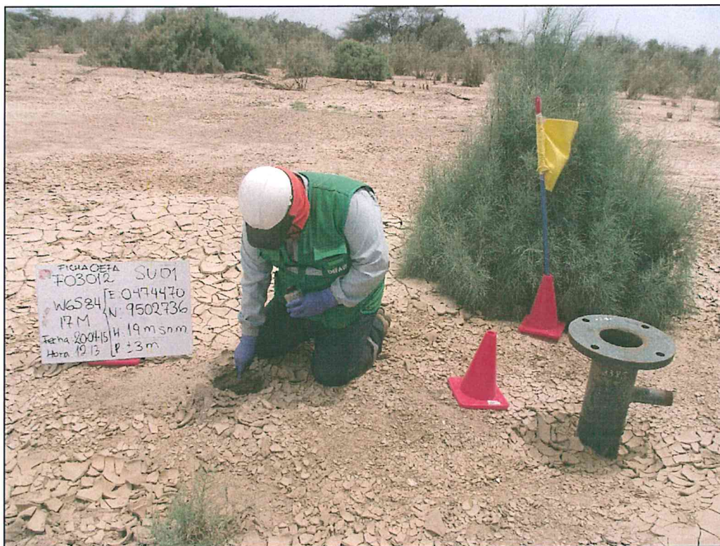
Fotografía N° 3. Toma de muestra de suelo en el punto F03012-SU01, ubicado a 1,2 m de distancia aproximadamente del Pozo T3385.
