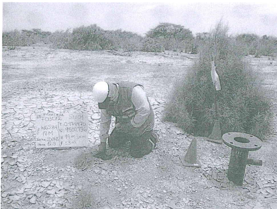
Fotografía N° 1. Toma de muestra de suelo en el punto F03012-SU01, ubicado a 1,2 m aproximadamente al oeste de la ubicación del pozo T3385
