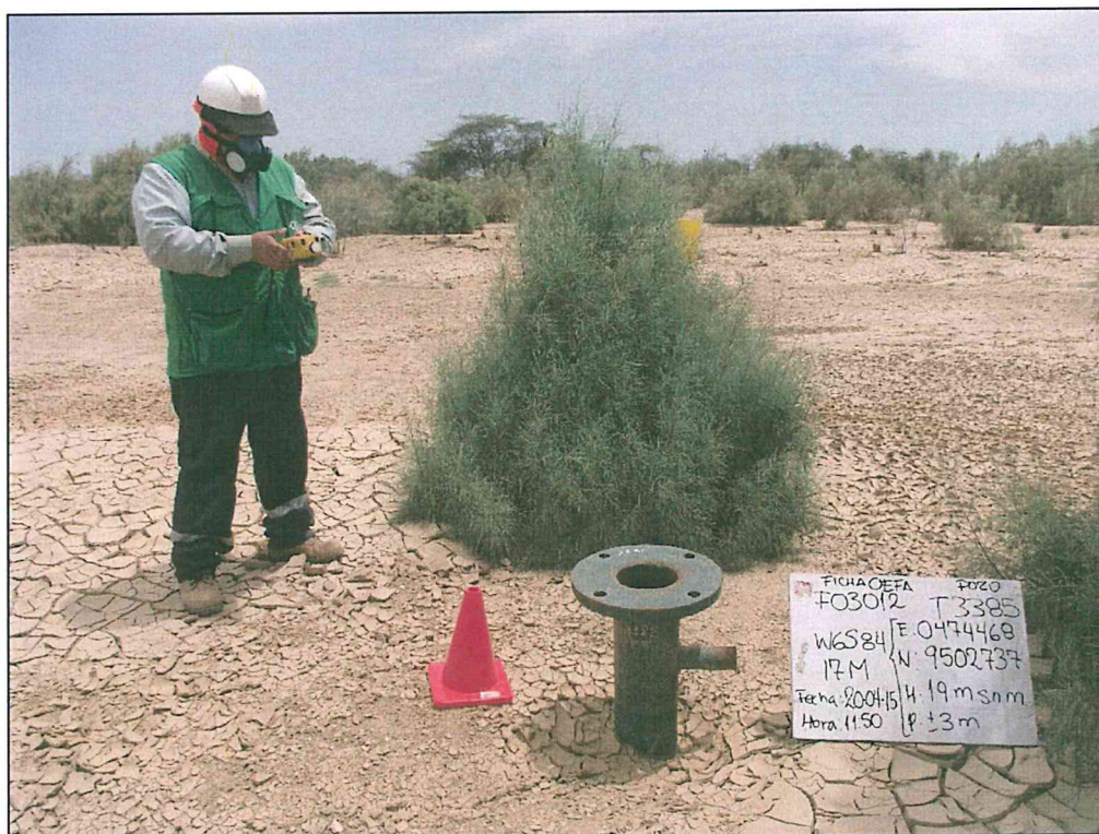
Fotografía N° 6. Mediciones en el punto F03012-VA01 alrededor del pozo T3385, en un radio de 1 m de distancia y con una duración de 5 minutos.
