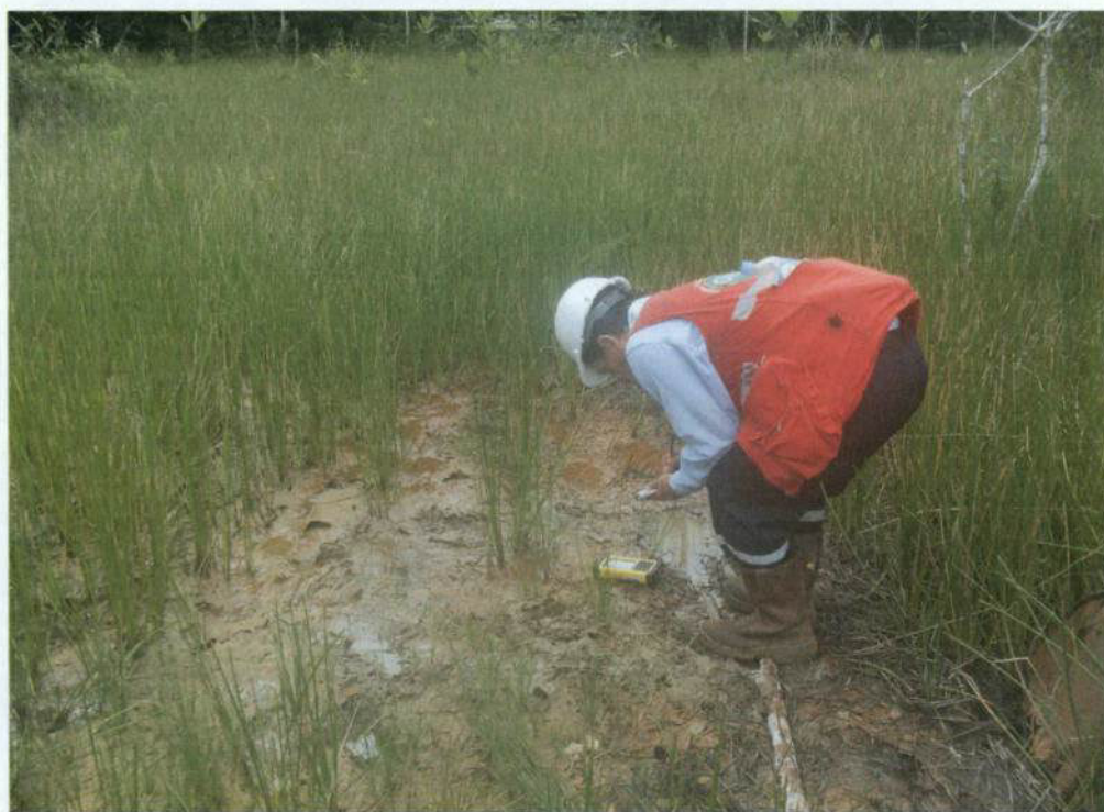
Foto N° 12: El supervisor del OEFA realizando la georeferenciación del punto de toma de muestra de suelo impactado por hidrocarburos a pocos metros del Pozo 74X.
