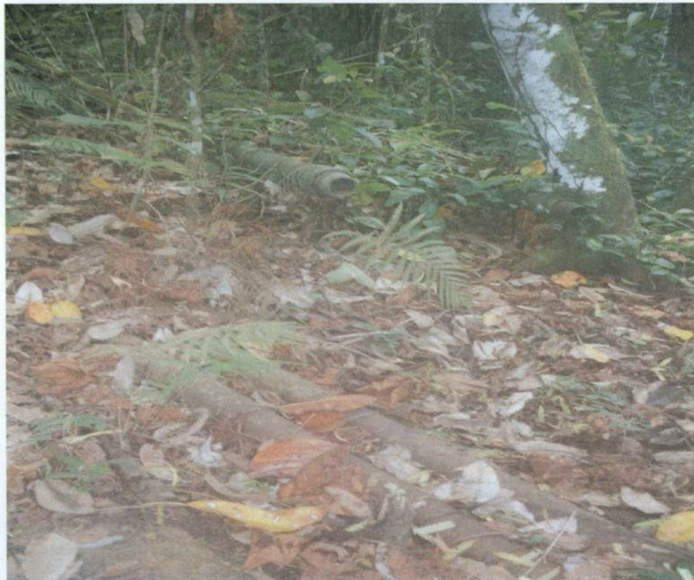
Foto N° 08: A 30 metros del primer punto, se encuentra restos de tuberías de perforación de 3.5" de diámetro y de una medida aprox. 20 metros de largo, todos ellos en estado de oxidación y abandonados a la intemperie.
