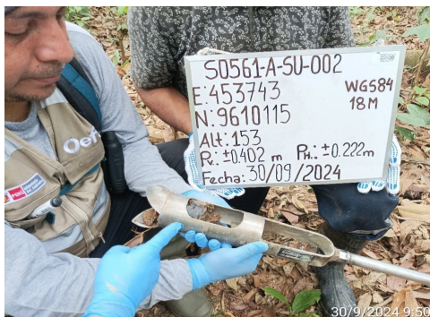
Vista de la toma de muestra de suelo con código S0561-A-SU-002. Se observó suelo seco de textura arcillosa y con indicios organolépticos de hidrocarburos
