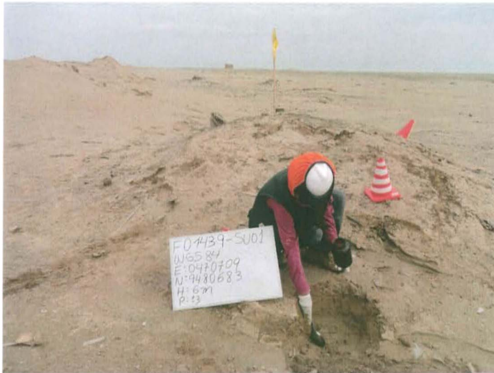
Fotografía N° 3. Recojo de la primera muestra de suelo F01439-SU01 realizado a 5 m del pozo.
