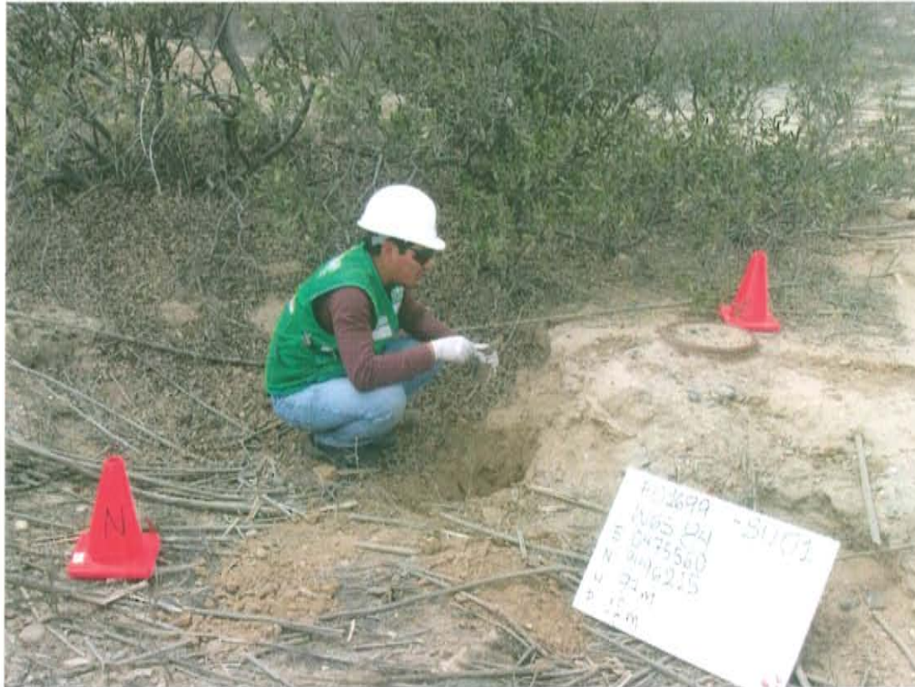
Fotografía N° 3. Toma de muestra de suelo en el punto F01699-SU01 ubicado a 0,7 m al norte del Pozo T3465.
