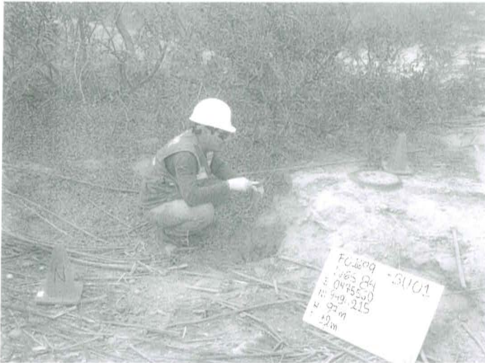
Fotografía N° 1. Toma de muestra de suelo en el punto F01699-SU01 ubicado a 0,7 m al norte del Pozo T3465
