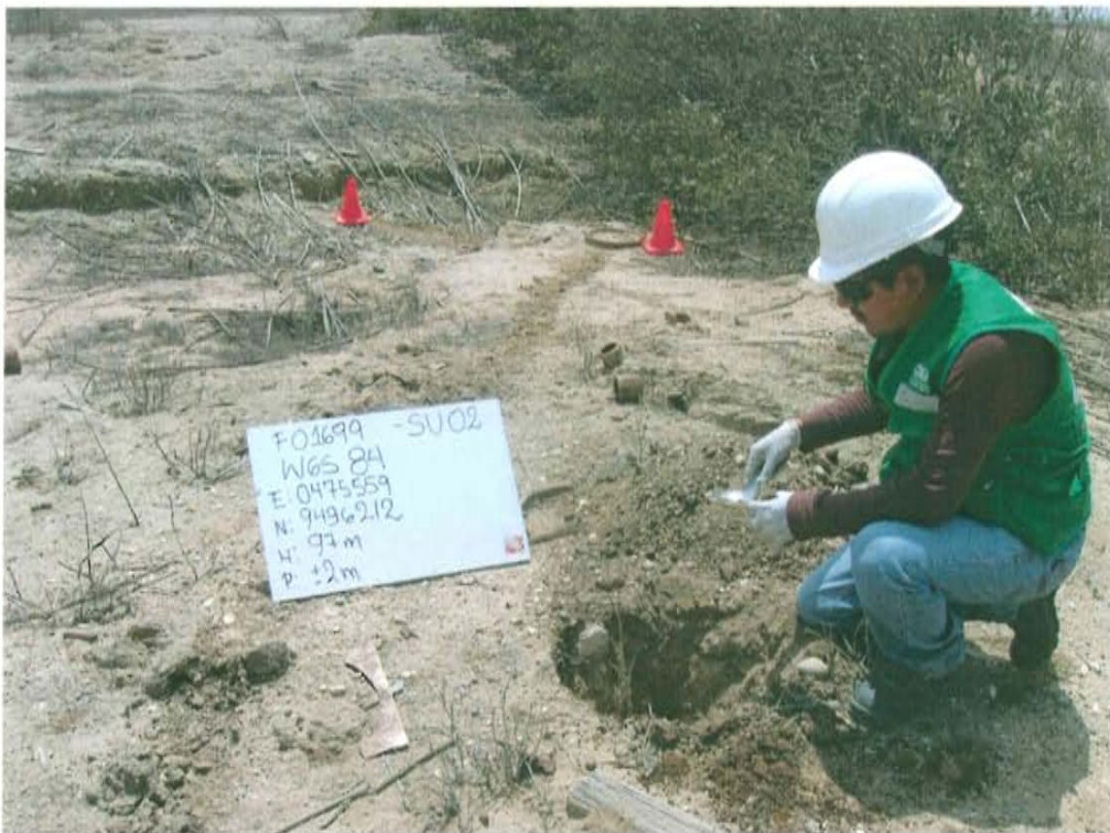
Fotografía N° 4. Toma de muestra de suelo en el punto F01699-SU02 ubicado a 6 m al sur del Pozo T3465.
